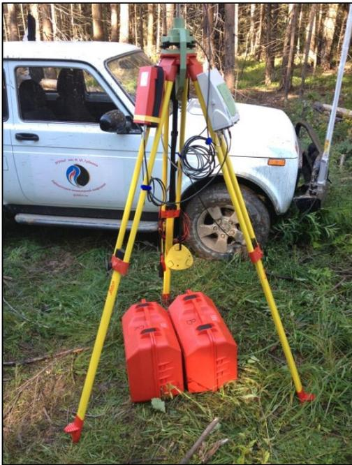
GNSS приемник Leica
