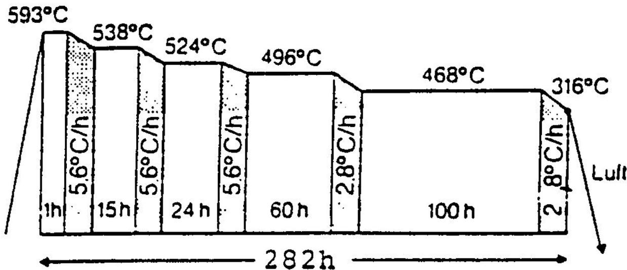
Чтобы оценить склонность материала к высокотемпературному охрупчиванию в лабораторных условиях, когда время охрупчивания необходимо сократить с нескольких десятков лет до сотен часов, образцы подвергают термообработке со ступенчатым охлаждением.
