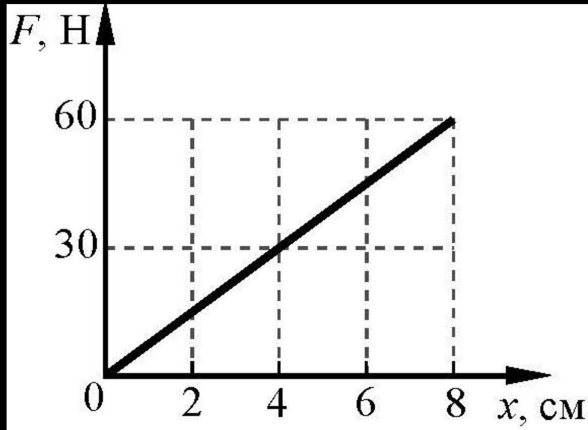
6. К системе из кубика массой 1 кг и двух пружин приложена постоянная горизонтальная сила  $F$  (см. рисунок). Система покоится. Между кубиком и опорой трения нет. Левый край первой пружины прикреплен к стенке. Жёсткость первой пружины  $k_1 = 300$  Н/м. Жёсткость второй пружины  $k_2 = 600$  Н/м. Удлинение второй пружины равно 2 см. Модуль силы  $F$  равен
