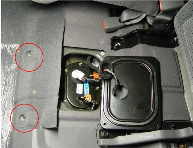
Для доступа к модулю топливного насоса отверните 2 болта крепления левой половины заднего сиденья, снимите лючок.
