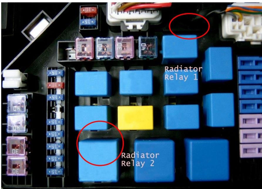
Реле вентилятора охлаждения двигателя
