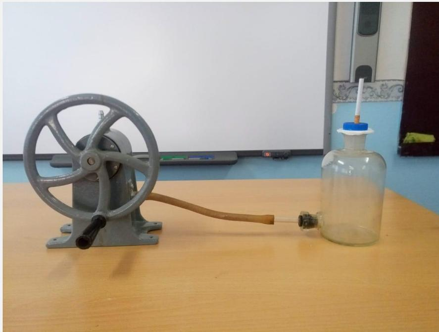
**Опыт 2.** Для опыта мы использовали вакуумный насос Комовского, к которому подсоединили сосуд из которого откачивали воздух в процессе выполнения опыта
