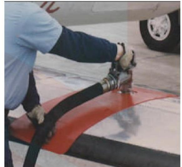
Открытая заправка должна выполняться **при низком давлении** во избежание «выскакивания» рукава и с целью предотвращения накопления статического электричества в системе "ВС - средство заправки". Скорость заправки должна регулироваться вручную срабатыванием РП. **РП следует держать в руке, не фиксировать в открытом положении.**
