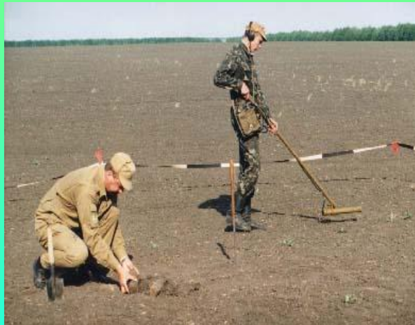
Розмінування місцевості з індукційним міношукачем ІМП-2
