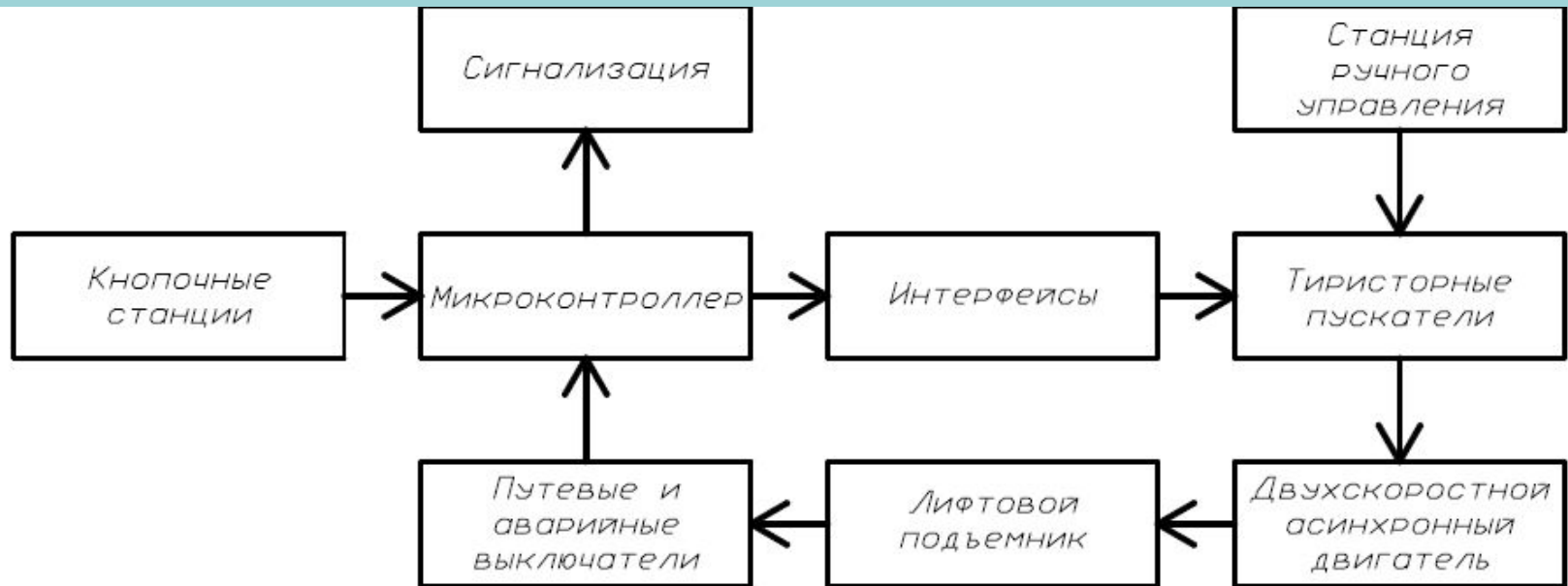
Структурная схема (функциональная структура) системы управления лифтовым подъемником
