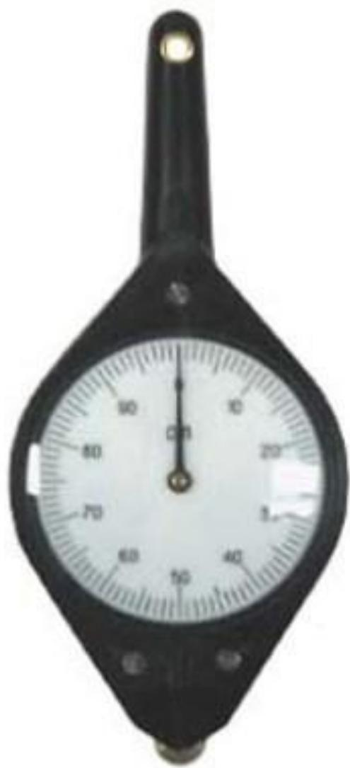
При движении колесика стрелка показывает путь, проходимый колесиком в сантиметрах.
