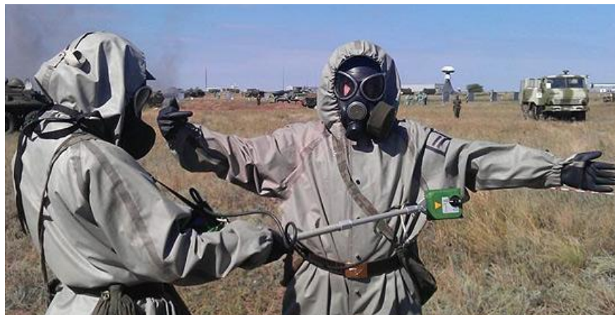
Определение степени заражения средств защиты РВ прибором ИМД-2НМ
