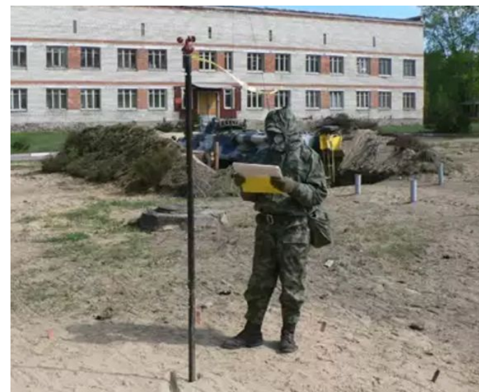
Определение метеоданных в приземном слое атмосферы с помощью МК-3
