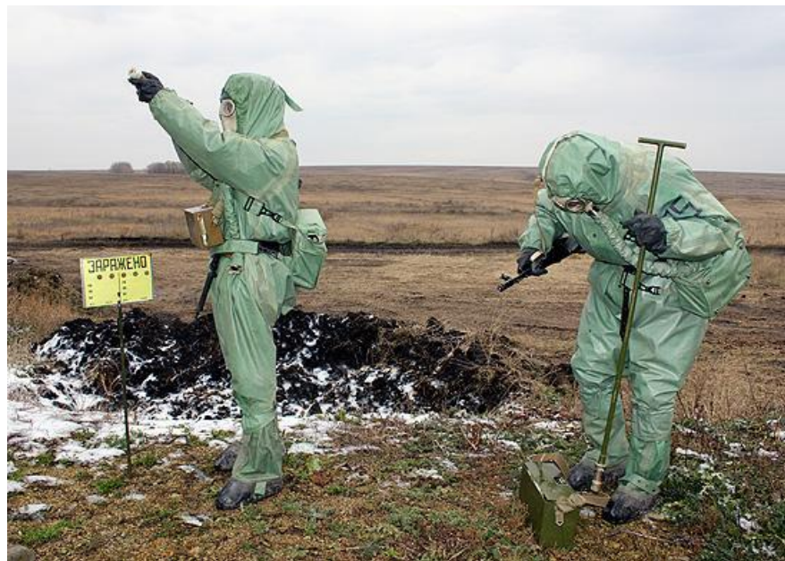
Отбор проб воздуха с помощью ВПХР, грунта с помощью КПО-1
