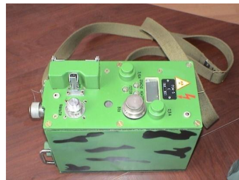
Переносной прибор химического контроля зараженности поверхности ВВТ (Опытный образец разрабатывается при выполнении ОКР «Велосипед-1»)
