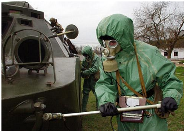
Определение степени заражения техники РВ прибором ДП-5В
