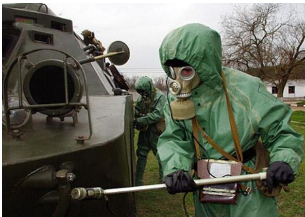
Определение степени заражения техники РВ прибором ДП-5В
