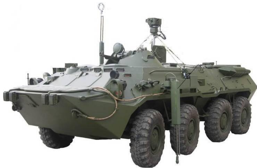
Прибор химической разведки дистанционного действия ПХРДД-2Б, установленный на РХМ-6
