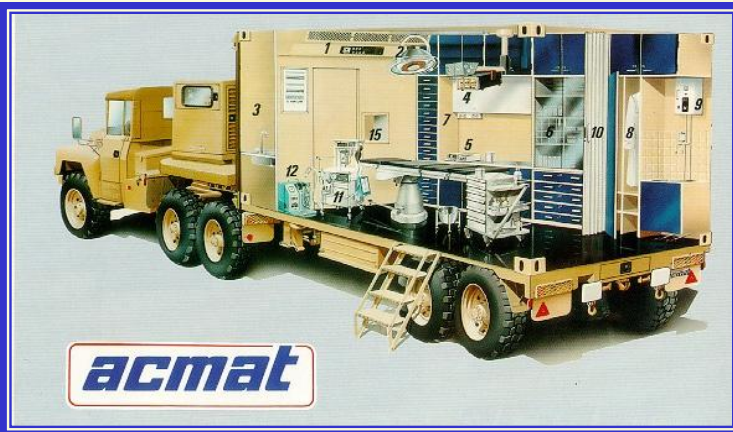
Модуль операционной на автопоезде Акмат (Франция)
