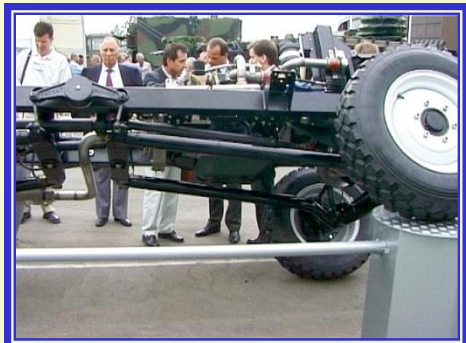
Последовательность работы подвески
