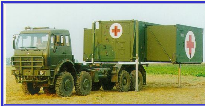
Кузов-контейнер переменного объема ф. Шелл (Германия) на шасси автомобиля Мерседес
