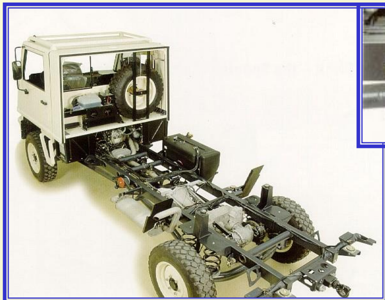
Оригинальная пружинная подвеска ф. Дьюро (Швейцария) с направляющей системой пространственной конфигурации
