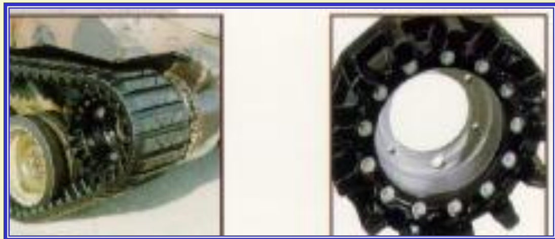
Ведущая звездочка из пластика
