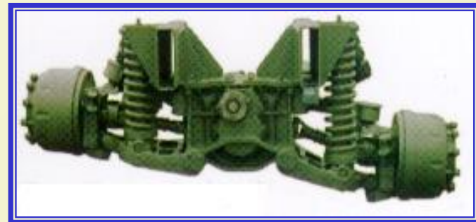
Независимые пружинные подвески фирм Меритор и Тимони
