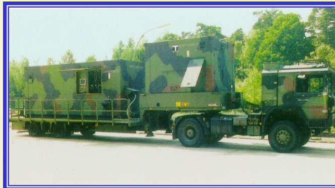
Мобильная станция очистки воды в кузовах-контейнерах ф. Шелл (Германия) на автопоезде МАН
