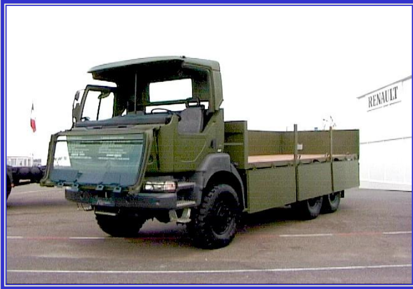
Откидывающиеся съемные боковые борта платформы автомобиля Рено (Франция)
