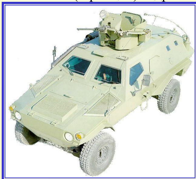
Бронированный сварной корпус
