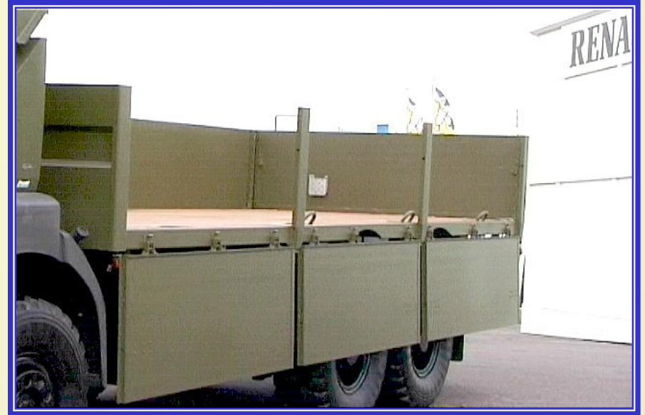
Откидывающиеся съемные боковые борта платформы автомобиля Рено (Франция)
