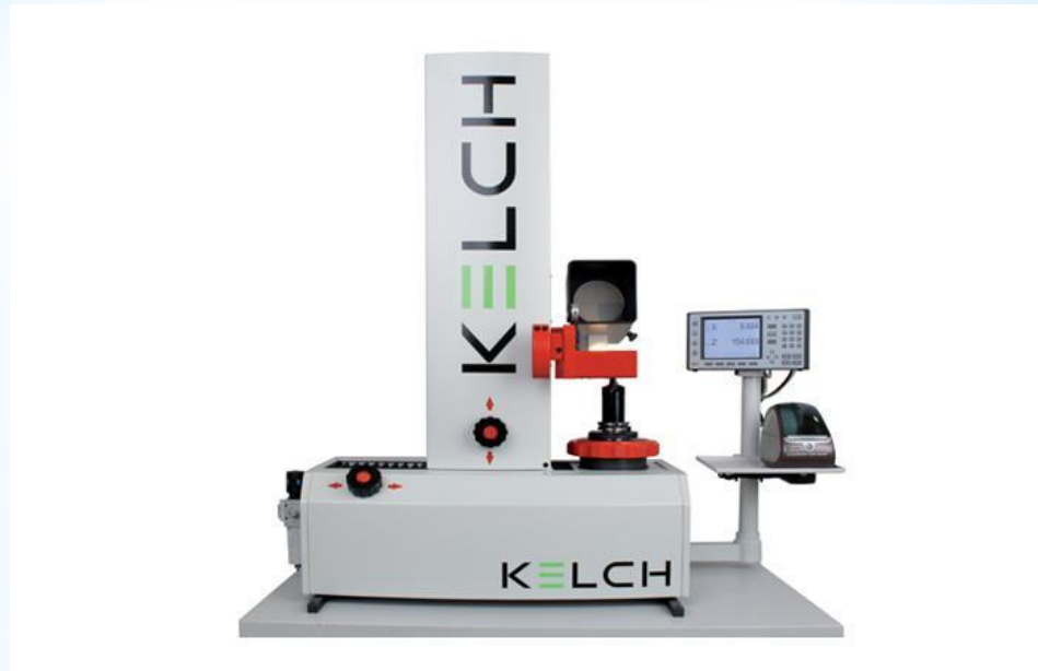
Рисунок - Пресеттер SECA E Micro (Устройство для измерения инструмента вне станка)
