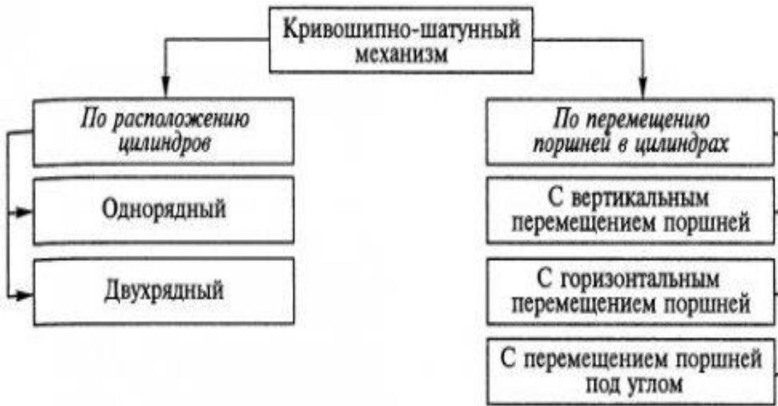
Рисунок 1 – Типы кривошипно-шатунных механизмов, классифицированных по различным признакам.
