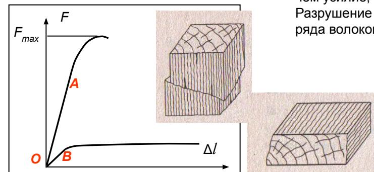
При сжатии поперек волокон на участке ОВ древесина работает почти упруго, деформации растут пропорционально увеличению сжимающей силы. Далее деформации начинают расти очень быстро при малом увеличении силы, вследствие уплотнения (спрессовывания) отдельных волокон. При наличии сучков и других пороков (трещин) образец может разрушиться раскалыванием. Разрушающая нагрузка определяется условно при достижении деформации сжатия, при которой высота образца уменьшается на треть исходной высоты .
