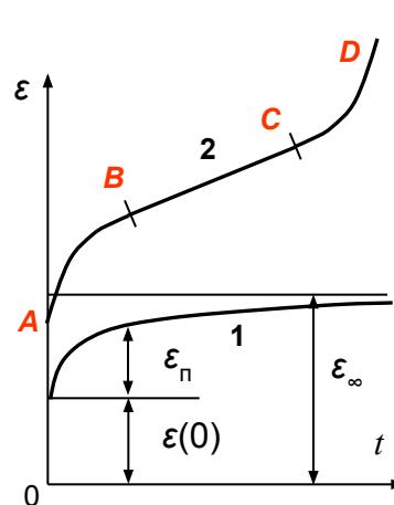
Результаты испытаний на ползучесть представляют графиками изменения деформаций во времени (*кривые ползучести*). В начальный момент времени деформации имеют ненулевое значение  $\varepsilon(0)$ , равное упругой деформации или сумме упругой и пластической деформаций. Считается, что время предварительной нагрузки (или разгрузки) пренебрежимо мало по сравнению со временем выдерживания нагрузки, поэтому можно принять, что деформации  $\varepsilon(0)$  и напряжение появляются как бы мгновенно.
