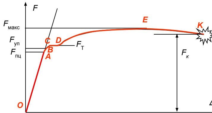
В точке К образец внезапно разрушается с резким ударным звуком, но без световых эффектов.
