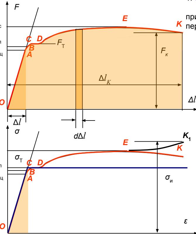
При статическом растяжении образца силой  $F$  элементарная работа на малом перемещении равна:  $dW = Fd\Delta l$ .
