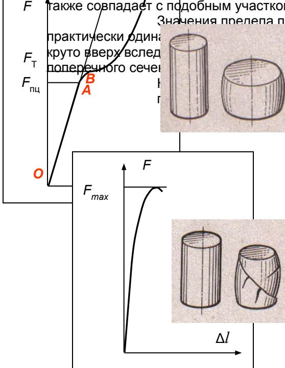
■ **Диаграмма чугуна** – Начальный участок диаграммы имеет почти линейную зависимость, на этом участке форма и размеры образца меняются незначительно. При приближении к максимальной нагрузке кривая становится более пологой и образец принимает слегка бочкообразную форму. При достижении нагрузкой наибольшего значения появляются трещины под углом примерно  $45^{\circ}$  и наступает разрушение по площадкам с наибольшими касательными напряжениями (хрупкое разрушение).
