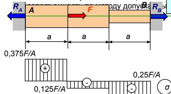
Теперь при  $F_{\text{пред}} = [F]n$  возникает текучесть еще на третьем участке и система уже не может воспринимать нагрузку (второй участок будет перемещаться вследствие текучести на первом и третьем участках). Грузоподъемность, определенная по методу разрушающих нагрузок, больше, чем определенная по методу допускаемых напряжений, на  $(0,375 - 0,25)/0,25 \cdot 100\% = 50\%$ , т.е. в 1,5 раза.
