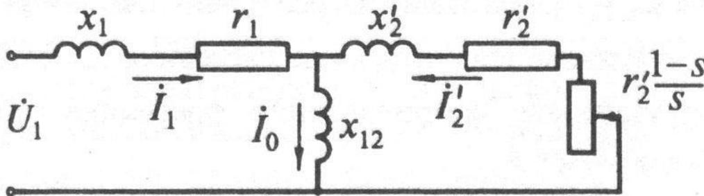
Схема замещения асинхронной машины, соответствующая уравнениям
