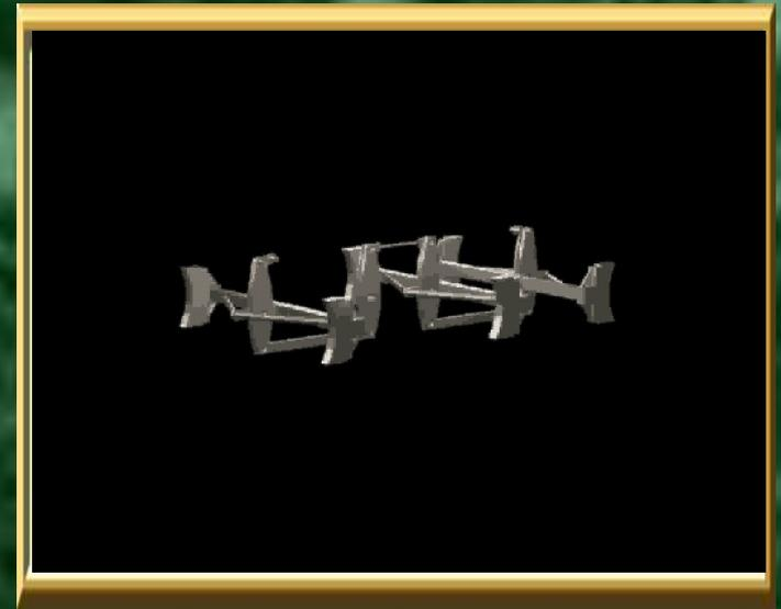
Тормозная рычажная передача выполнена с односторонним нажатием колодок на колёса. В эксплуатации имеются так же полувагоны с двух сторонним нажатием колодок на среднюю ось тележки и односторонним – на крайние оси.
