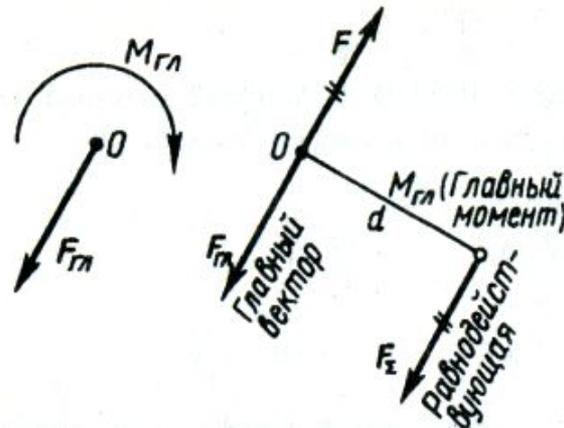
4. **Главный вектор и равнодействующая эквивалентны лишь в частном случае, когда главный момент системы равен нулю, а это при случае, когда центр приведения находится на линии действия равнодействующей**
