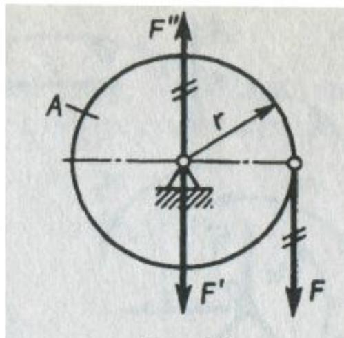
Для определения действия силы  $F$  на колесо и подшипники перенесем эту силу параллельно самой себе на ось колеса.
