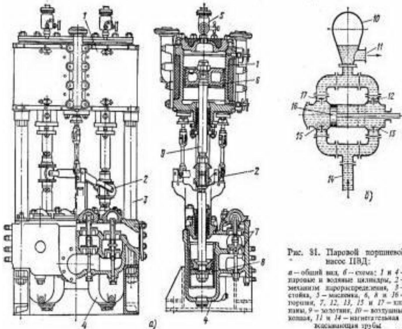
Рис. 31. Паровой поршневой насос ПВД:
