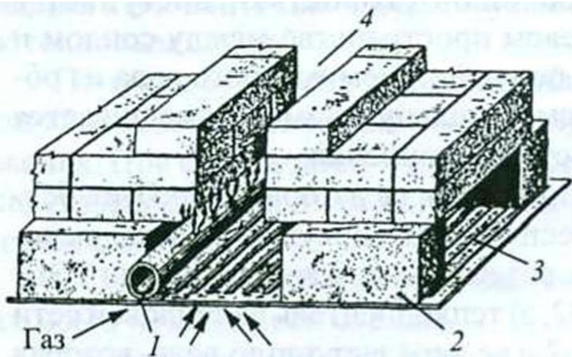
*Рис. 103.* Диффузионная подовая горелка:
