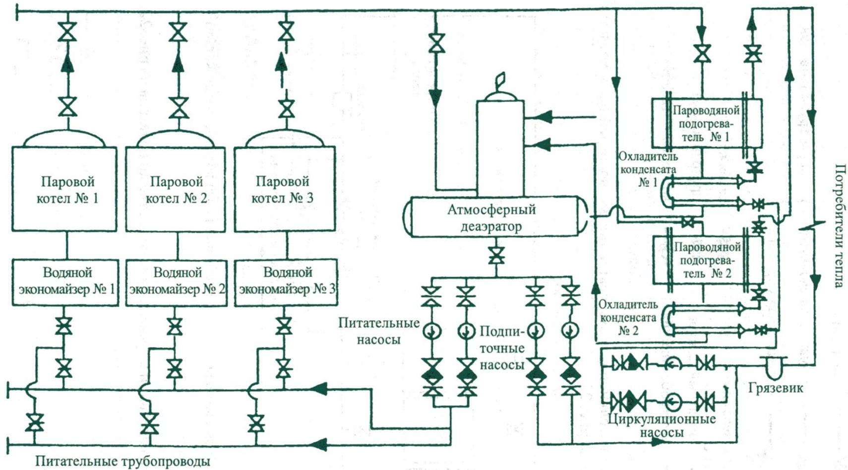
Рис. 22. Схема котельной с тремя паровыми котлами
