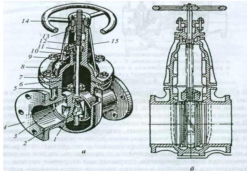
Рис. 36. Параллельная задвижка:
