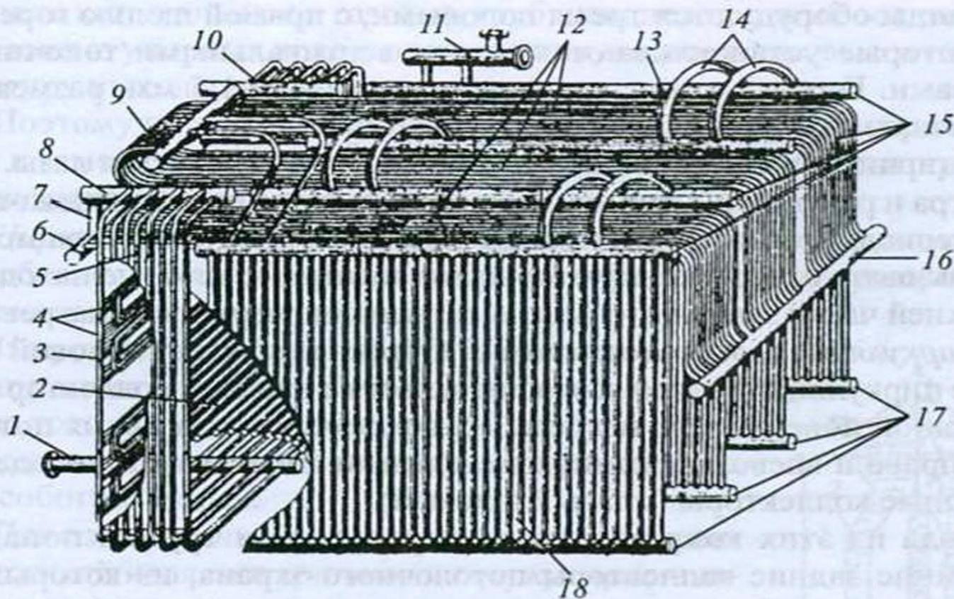
**Рис. 71.** Трубная часть котла водогрейного КВГ-6,5-150: коллекторы: 1 – входа обратной воды; 6 и 9 – задние; 8 и 10 – верхние боковые конвективной части; 11 – выход горячей воды; 15 – верхние потолочные экраны; 16 – передний; 17 – нижние топочные экраны; перегородки: 2 – из труб; 3 – в трубах конвективной части; 13 – в верхних коллекторах топочных экранов; 4 – пакеты змеевиков; экраны: 5 – конвективные; 12 – потолочный, переходящий во фронтной; 18 – боковой; 7 и 14 – перепускные трубы
