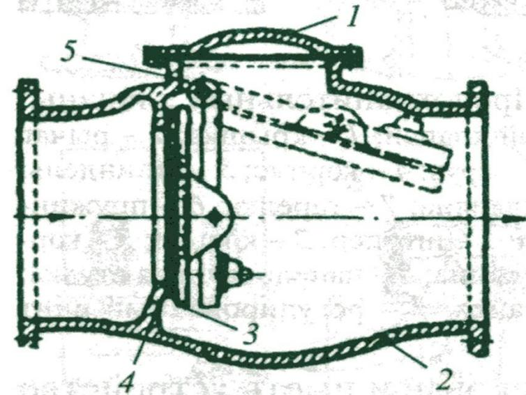
*Рис. 47.* Поворотный обратный клапан:
