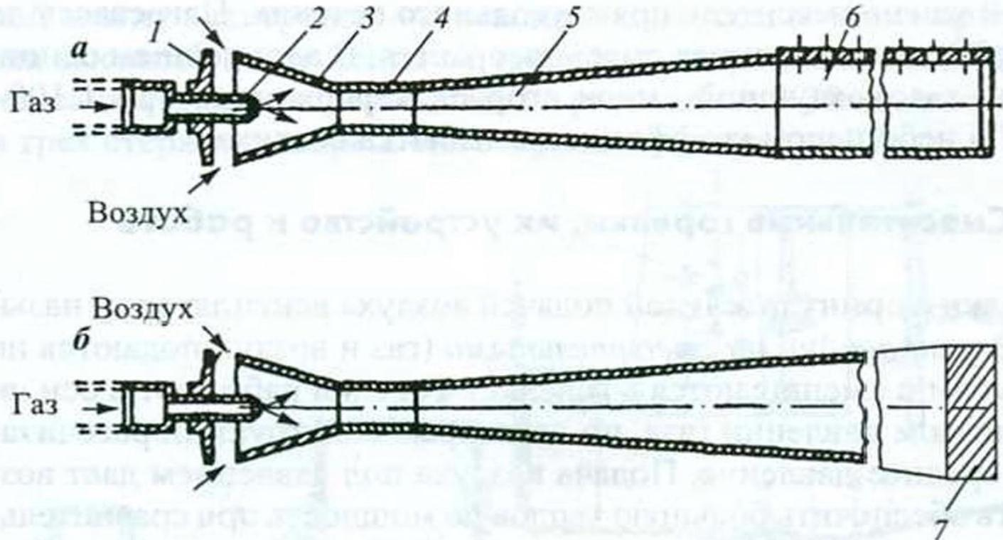
*Рис. 104.* Схемы инжекционных горелок:
