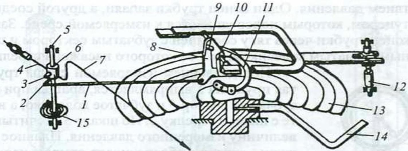
**Рис. 4.** Схема показывающего мембранного тягонапоромера ТМ-III:
