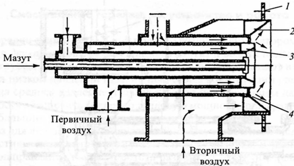
**Рис. 107.** Схема газомазутной горелки ГМГ и НГМГ:
