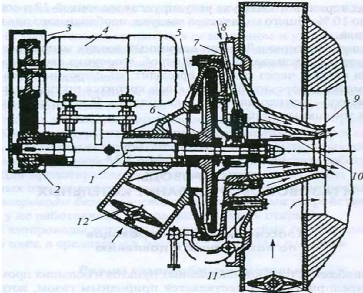
Рис. III. Ротационная форсунка Р-90-II:
