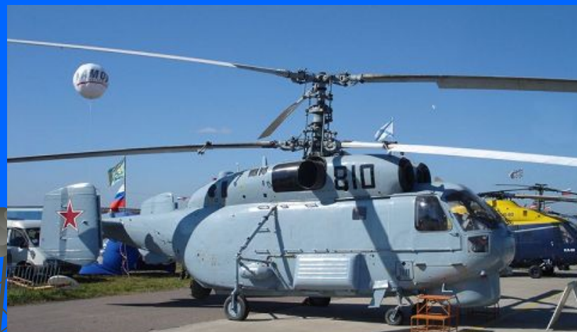
Вертолет Ка-32 с двумя соосными несущими винтами
