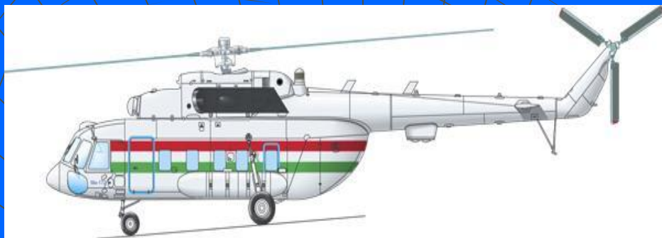
Вертолет Ми-8 с несущим и рулевым винтом
