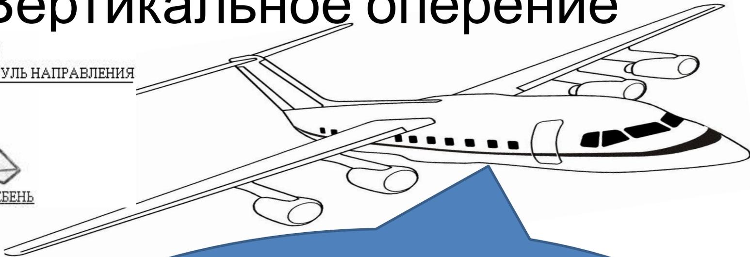
Обеспечивает самолёту путевую устойчивость, управляемость и балансировку относительно вертикальной оси. Оно состоит из неподвижной поверхности — киля и шарнирно подвешенного к нему руля направления.
