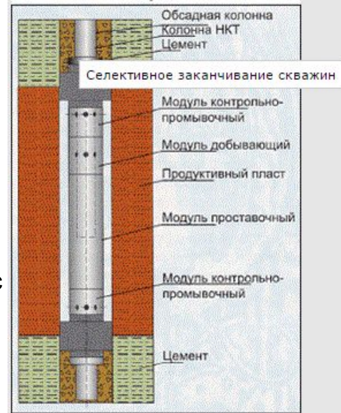
Схема установка инструмента селективного заканчивания скважин
