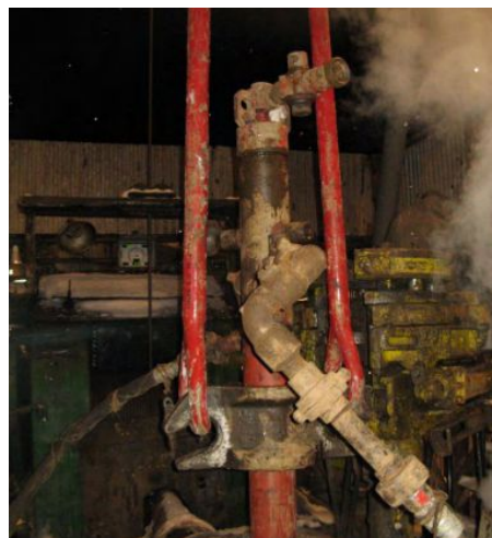
Вид удлиненных штропов и гибких тампонажных рукавов, присоединенных к цементировочной головке
