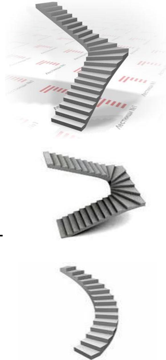
■ на косоурах (лестница, ступени которой поддерживаются снизу балками (косоурами) с двух сторон либо одной центральной, на косоурную балку, имеющую пилообразную форму, сверху укладывают ступени, с торца — подступенки.)
