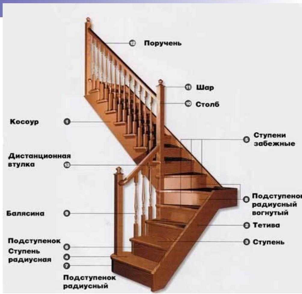
**Ступени. Тетивы. Марши. Площадки.** Ступени делают из досок толщиной 50 мм. Тетиву из доски толщиной 50—60 мм. Ширина марша — не менее 1050 мм. Ширина площадки - не менее 1200 мм. **Уклон.** В двухэтажных домах уклон 1:1,5. Уклон на мансарду может быть более крутым. **Проступи. Ступени.** Ширина проступи - не менее 250 мм. Высота ступени не более 180 мм. Число ступеней в марше не более 16, но не менее 3.
