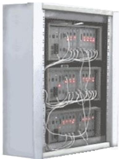
Центральная приемо-передающая станция. ЦППС строится на базе контроллеров, выполняющих работу по сопряжению с объектом контроля и управления передачу данных по каналам связи на пункт управления системой, прием данных на пункте управления, обработку и передачу данных в ЭВМ
