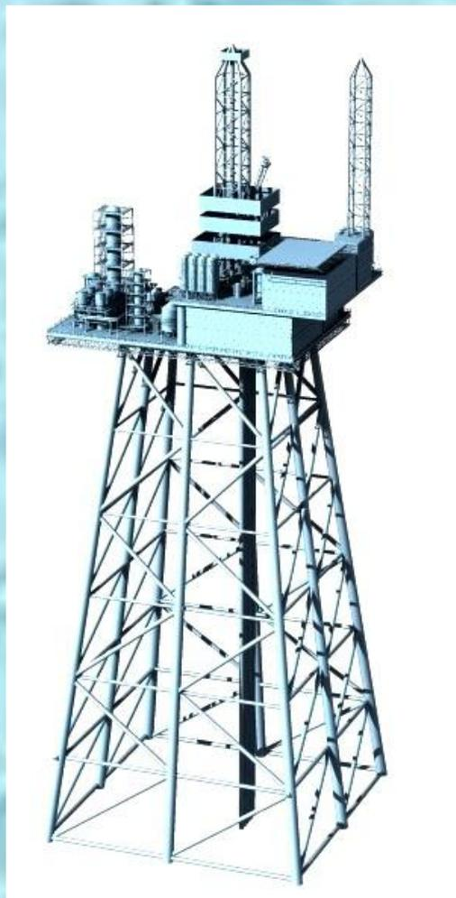
Термином «стержневые стационарные» называются платформы, имеющие три основных блока (или части): свайный фундамент, стержневая несущая конструкция и верхняя часть, которая собственно и является платформой, т.е. площадкой, на которой размещается технологическое оборудование и помещения для обслуживающего персонала. Дадим краткое описание каждой части платформы.
