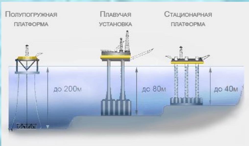
В зависимости от глубины применяют различные технологии. На мелководье обычно сооружают укрепленные «острова», с которых и осуществляют бурение. Именно так нефть издавна добывалась на Каспийских месторождениях в районе Баку. Применение такого способа, особенно в холодных водах, часто сопряжено с риском повреждения нефтедобывающих «островов» плавучими льдами. Например, в 1953 году, большой ледяной массив, оторвавшийся от берега, уничтожил около половины нефтедобывающих скважин в Каспийском море.
