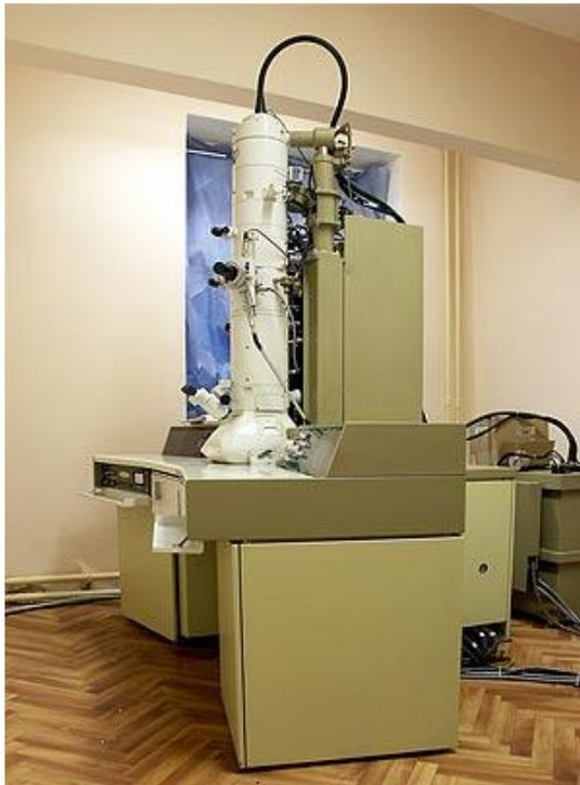
Просвечивающие электронные микроскопы (ПЭМ): электронный пучок пропускается через тонкие слои исследуемого вещества.
