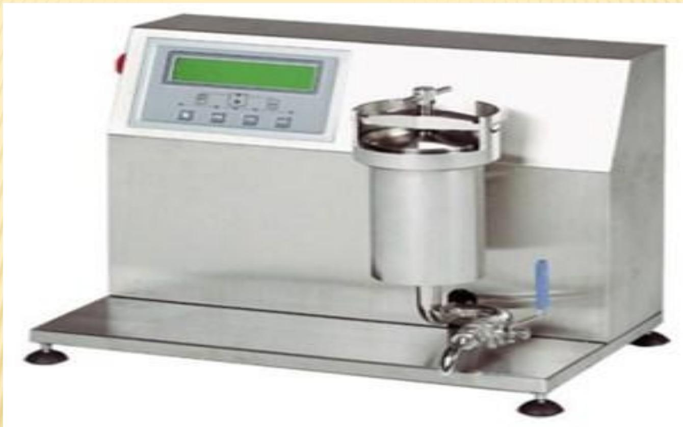
Экстрактор используется в фармацевтике для избирательного извлечения одного или нескольких компонентов из растворов и сухих составов с помощью растворителей. Способствует получению концентрированных вытяжек, очищенных от посторонних и балластных веществ.
