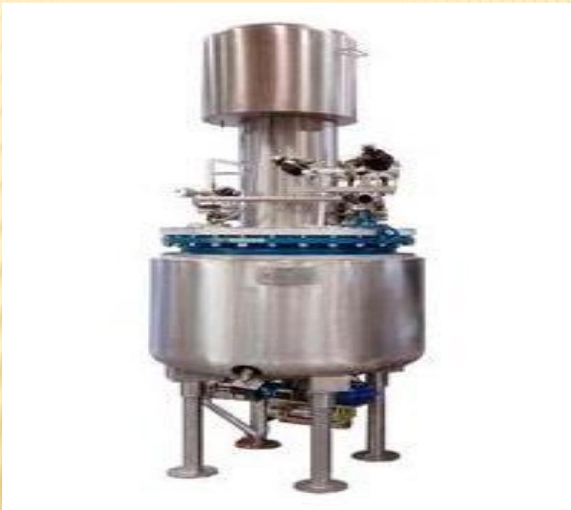
Фармацевтический реактор принадлежит к числу базового оборудования, используемого для выпуска жидких и вязких лекарственных форм (мазей, эмульсий, капель, микстур, инфузионных растворов, сывороток, вакцин). Создает необходимую температурно-химическую среду для растворения, гомогенизации, диспергирования веществ.
