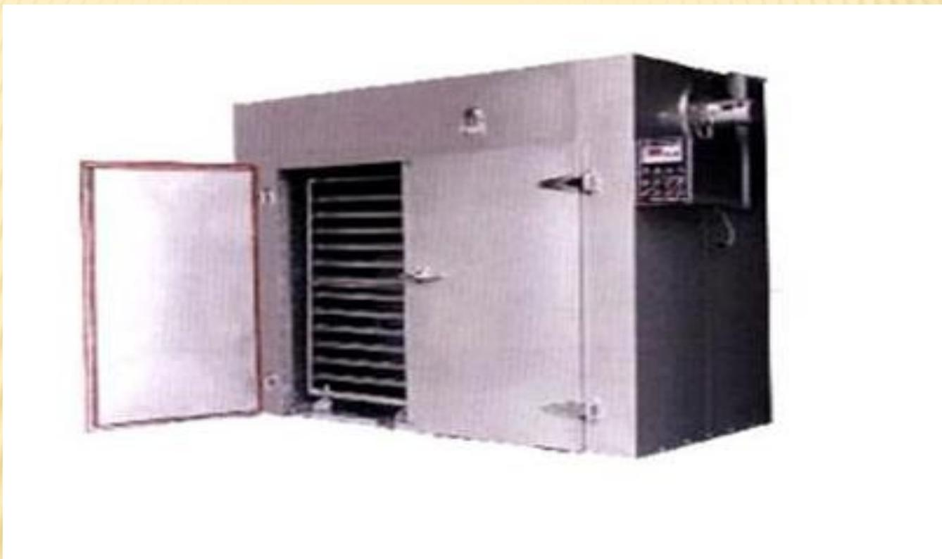
**Сушилка — часто применяемое в фармацевтике приспособление, с помощью которого снижают уровень влажности твердых и порошкообразных веществ для лучшего сохранения и пролонгации их полезных свойств, точного соблюдения рецептуры приготовления медикаментов.**
