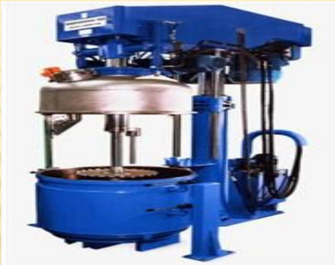
**Диссольвер — аппарат, используемый в фармацевтическом производстве для изготовления коллоидных растворов.** Прибор распределяет твердые вещества в жидкости таким образом, что они не осаждаются, а постоянно находятся во взвешенном виде. Полученные коллоидные системы характеризуются близкой к 100% усвояемостью и высокой лечебной активностью.
