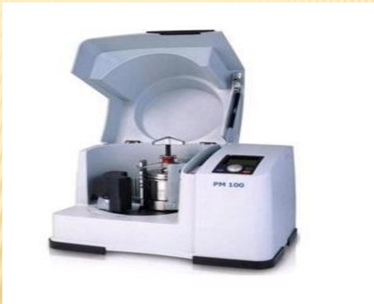
**Шаровая мельница – компактное устройство, позволяющее быстро переработать немалый объем сырья.** Шаровая мельница используется в фармацевтике для дробления твёрдых веществ и смешивания жидкостей с помощью сферических измельчителей разного размера и плотности. Это оборудование часто применяют в производстве порошковых и гранулированных медикаментов, эмульсий и суспензий.
