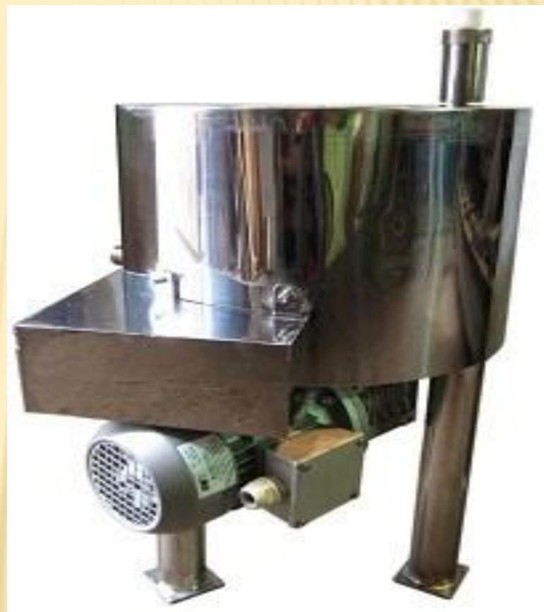
Жиротопка используется в фармацевтической промышленности для расплавления твердых липидов. Является обязательным элементом оснащения участков по производству мазей, гелей, кремов и других жиросодержащих препаратов.
