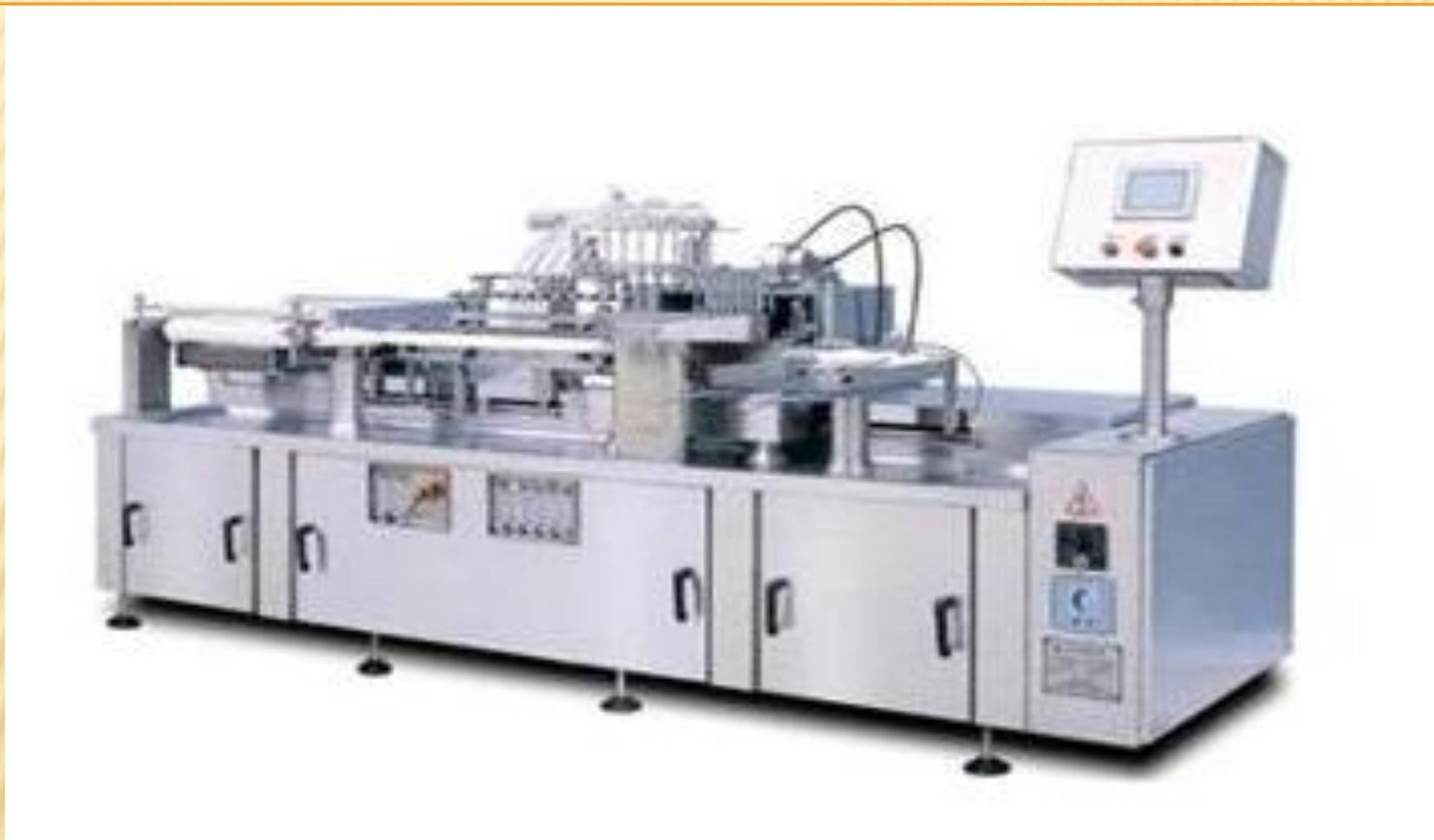
**Машины запайки — автоматические и полуавтоматические технические устройства, предназначенные для герметичной закупорки емкостей с жидкими и порошкообразными медикаментозными средствами.**
