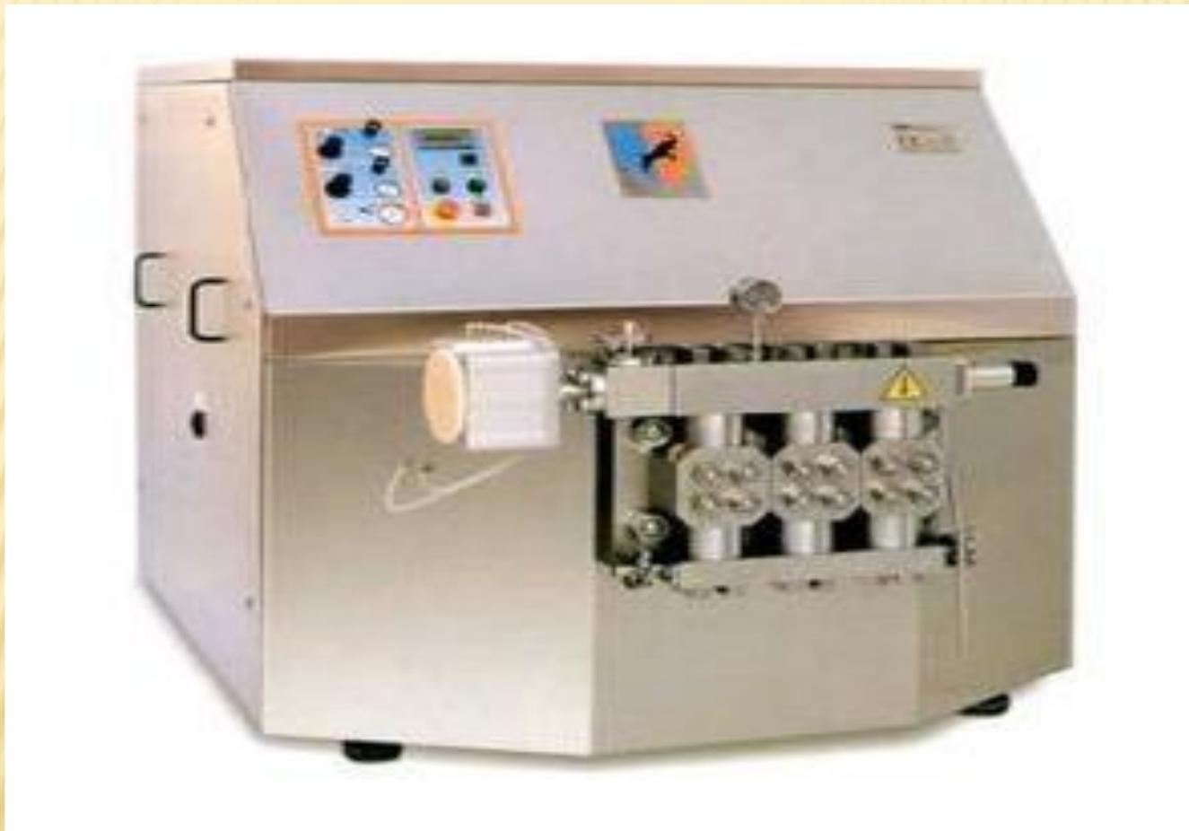
Гомогенизатор используется на фармацевтических предприятиях для получения однородных смесей со стабильной структурой и заданными химическими свойствами. Наиболее часто этот тип устройства применяют для работы с двумя и более взаимно не растворимыми жидкостями, а также для измельчения взвешенных в субстанциях частиц.
