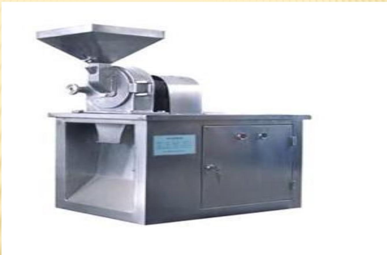
Измельчитель универсальный применяется в фармацевтической промышленности для дробления твердых веществ, преобразования их в сыпучие материалы, состоящие из частиц малого диаметра.
