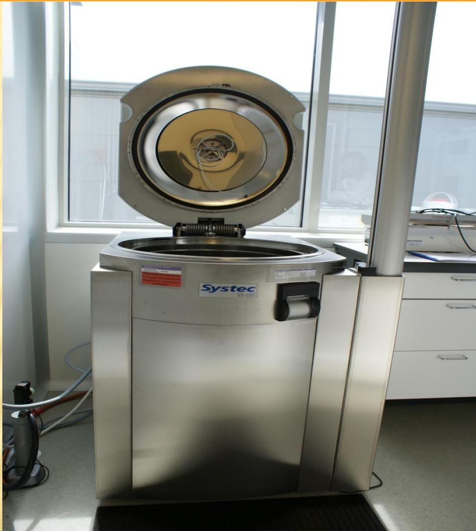
**Автоклав — устройство для создания разогретой рабочей среды в условиях высокого давления.** Применяется в фармацевтике для проведения химического синтеза и стерилизации.
