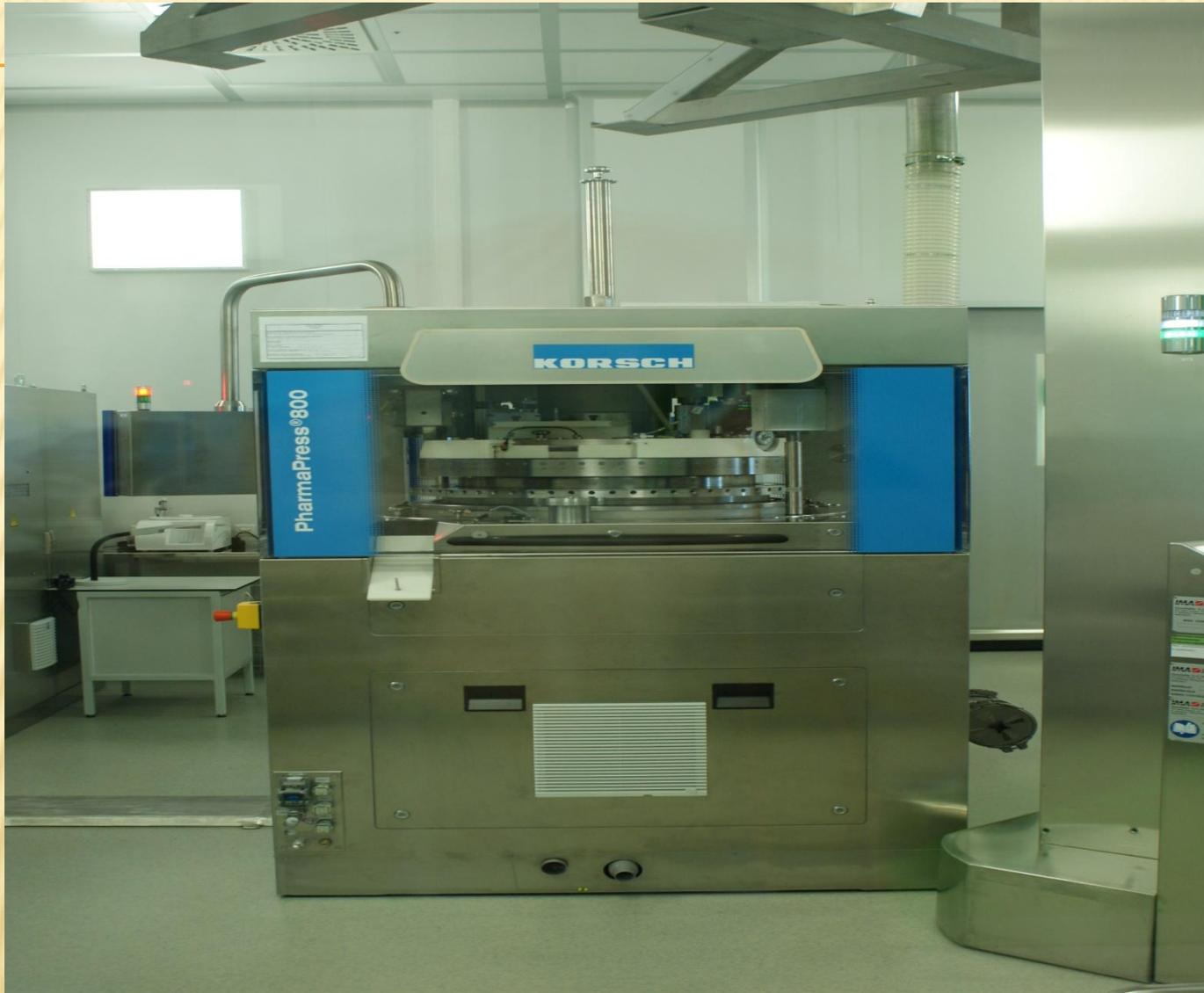
**Таблетпресс — техническое приспособление, применяемое в фармацевтике для изготовления дозированных медикаментов. В основу работы устройства заложено механическое сдавливание исходного материала для придания ему требуемой плотности и формы.**
