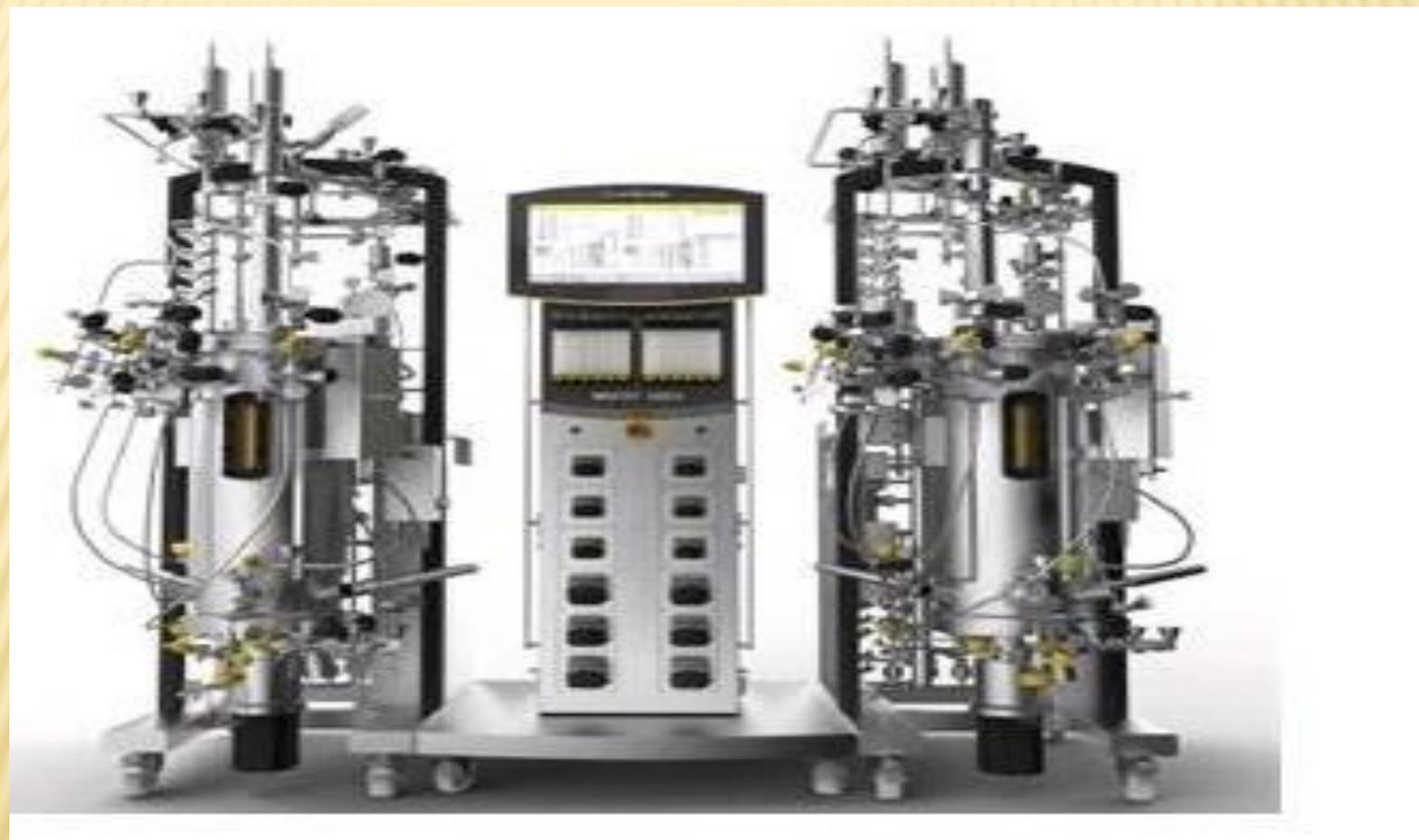
**Биореактор (ферментер) — устройство, создающее питательную стерильную среду с нормальным воздухообменом и постоянной температурой для культивирования микроорганизмов в условиях интенсивного перемешивания. Часто применяется в производстве лекарственных препаратов и вакцин.**
