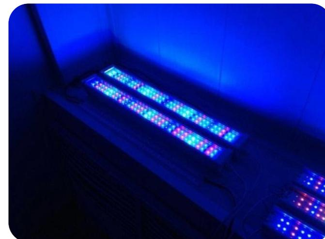
**Индивидуальный спектр** – это спектр, собранный по техническому заданию заказчика, либо разработанный агротехнологами «ФИТЭКС» на базе узкополосных дискретных светодиодов.
