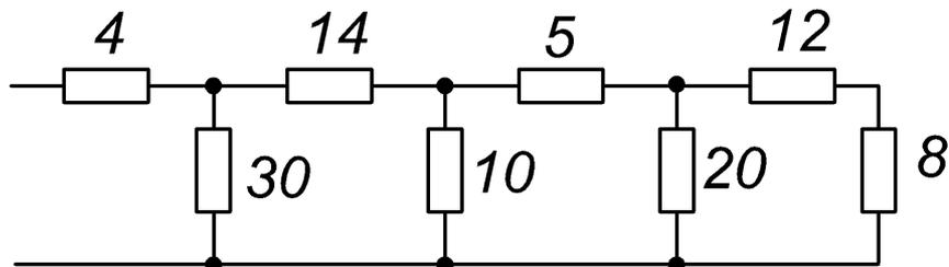
Задача 2. Определить токи электрической схемы, сопротивления ( $R$ ) которой представлены в омах.
