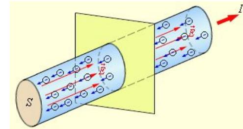
**ЭДС** определяется работой, совершаемой сторонними силами при перемещении единичного положительного заряда. Количественно ЭДС характеризуется работой  $A$ , которая совершается при перемещении заряда в один Кулон в пределах источника от отрицательного полюса источника к положительному к величине этого заряда.
