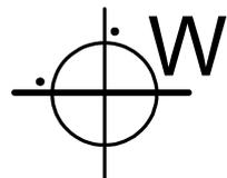
Ваттметр: прибор для измерения активной мощности.
