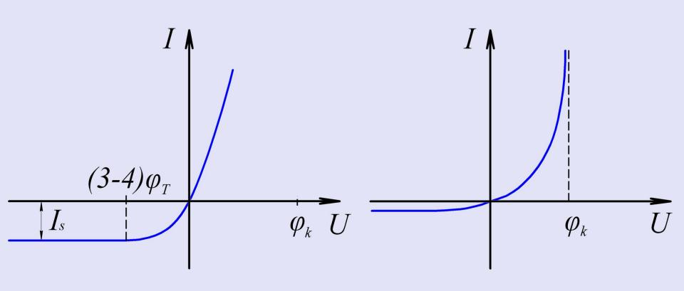
Выпрямительный, или силовой, диод — прибор, предназначенный для выпрямления переменного тока. Их применяют в цепях управления и коммутации, для развязок в электрических цепях, ограничения выбросов напряжений в цепях с индуктивными элементами, а также в цепях, где необходимы вентильные элементы и не предъявляется жестких требований к временным и частотным параметрам.
