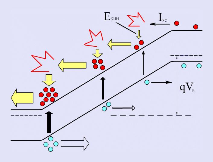
Коэффициент лавинного умножения *М*, определяемый как количество актов лавинного умножения в области сильного электрического поля, для которого справедливо следующее эмпирическое соотношение Миллера:
