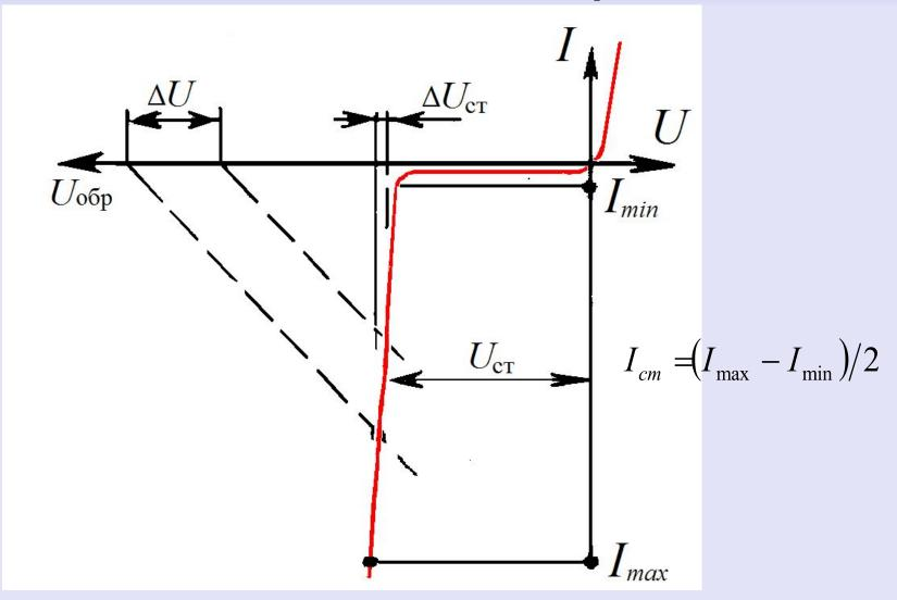
Основными характеристиками стабилитрона являются ток  $I_{cm}$  и напряжение  $U_{cm}$  стабилизации, дифференциальное напряжение стабилитрона  $r_{\partial}$  и температурная зависимость этих параметров.
