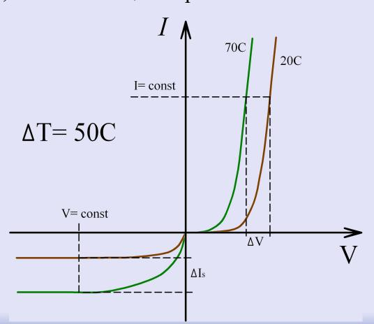
Изменение температуры диода может произойти не только вследствие изменения температуры окружающей среды, но и за счет саморазогрева *pn*-перехода при больших плотностях протекающего через него токов.
