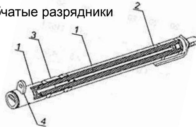
Конструктивно трубчатый разрядник представляет собой аппарат, состоящий из закрытого искрового промежутка, образованного двумя металлическими электродами (1) внутри виниловой трубы (2), на одном конце которой укреплен открытый металлический наконечник (3). Внешний искровой промежуток образован стальными стержневыми электродами, один из которых с помощью зажима (4) присоединен к открытому наконечнику. Крепление разрядников осуществляется с помощью хомутов.
