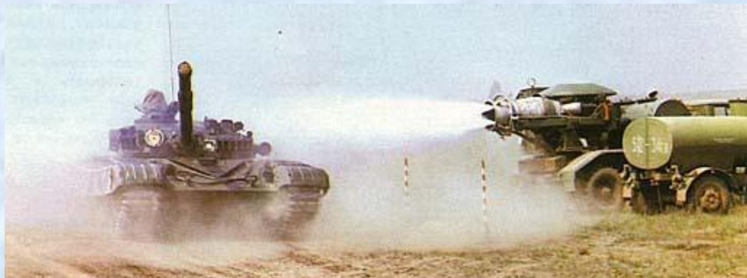
Спецобработка колонны танков тепловой машиной ТМС-65
