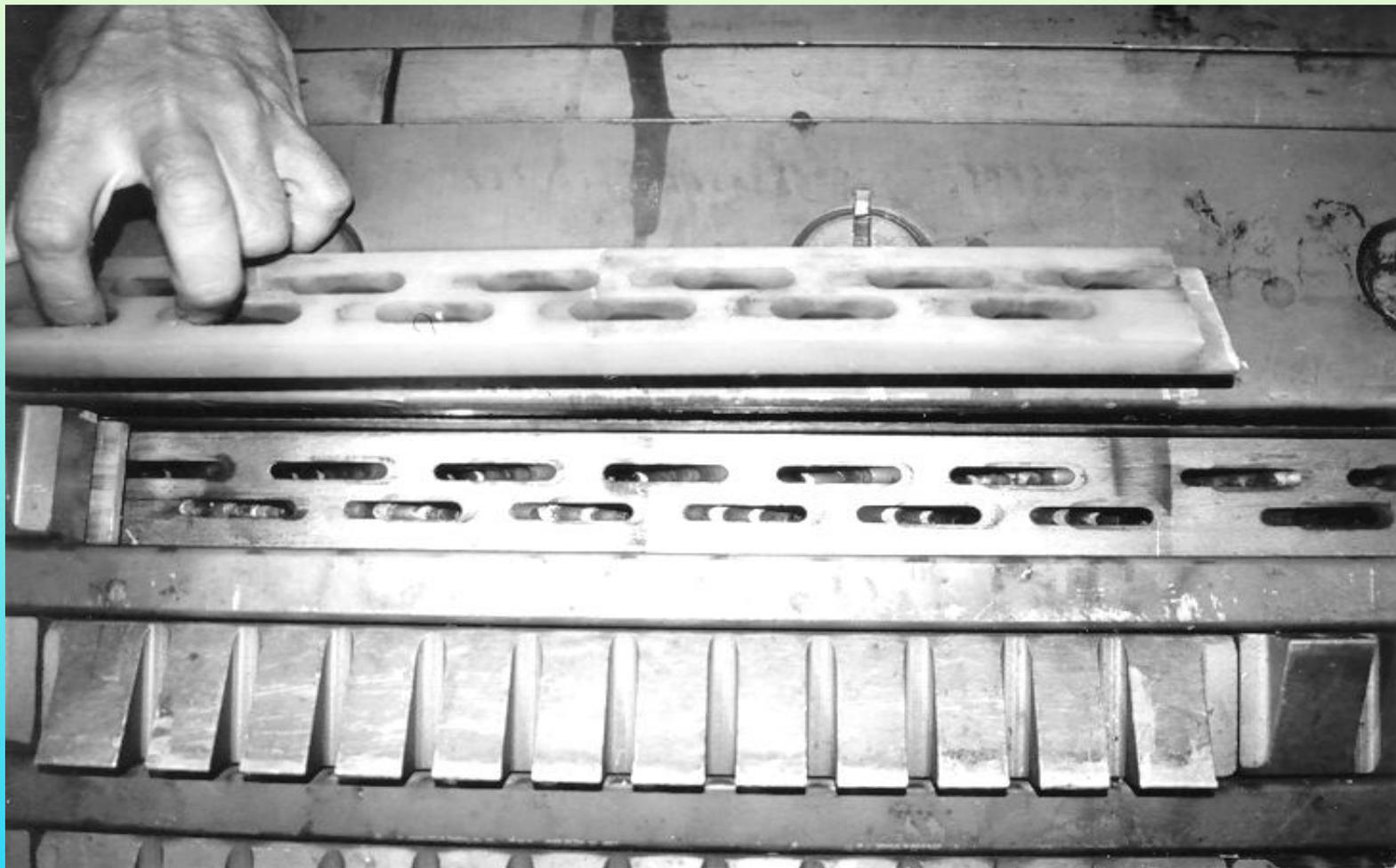
**В пазу видна медная шина обмотки. Сверху (в руке) - стеклотекстолитовая подклиновная прокладка. Внизу пазовый клин с заборными отверстиями.**
