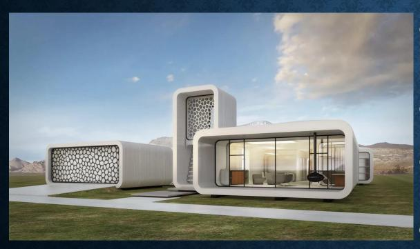
Строительный 3D-принтер в своей работе использует технологию экструдирования, при которой каждый новый слой строительного материала выдавливается из принтера поверх предыдущего слоя. 3D-печать позволяет получить уникальные бетонные формы без опалубки, существенно сократи при этом затраты живого труда и время сдачи объекта.
