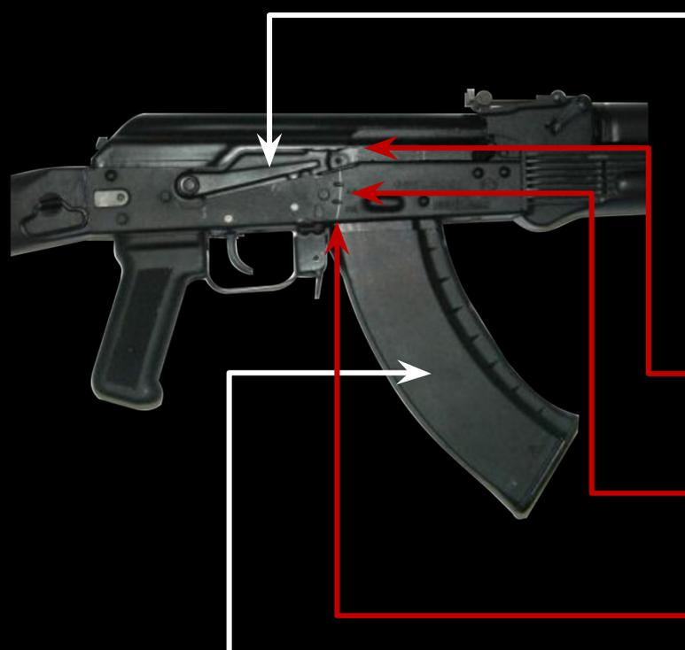
ПЕРЕВОД АВТОМАТА НА АВТОМАТИЧЕСКИЙ И ОДИНОЧНЫЙ ОГОНЬ ПРОИЗВОДИТСЯ С ПОМОЩЬЮ ПЕРЕВОДЧИКА-ПРЕДОХРАНИТЕЛЯ ФЛАЖКОВОГО ТИПА, ИМЕЮЩЕГО ТРИ ПОЛОЖЕНИЯ:
