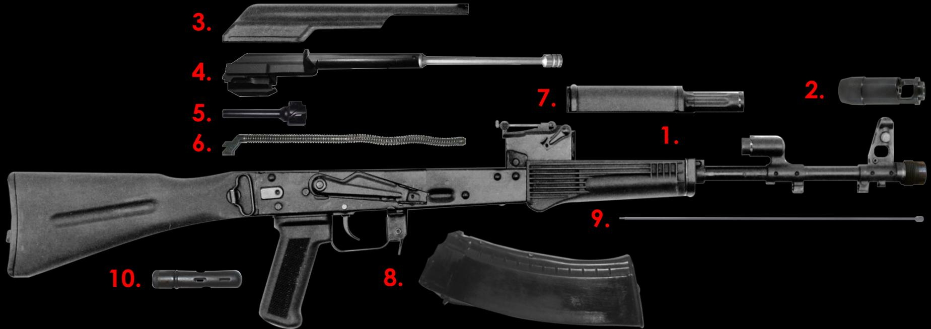
**1. СВОЛ СО СВОЛЬНОЙ КОРОБКЕЙ, ПРИЦЕЛЬНЫМ ПРИСПОСОБЛЕНИЕМ, ПРИКЛАДОМ, ПИСТОЛЕТНОЙ РУКОЯТКОЙ, УДАРНО-СПУСКОВЫМ МЕХАНИЗМОМ И ЦЕВЬЕМ**
