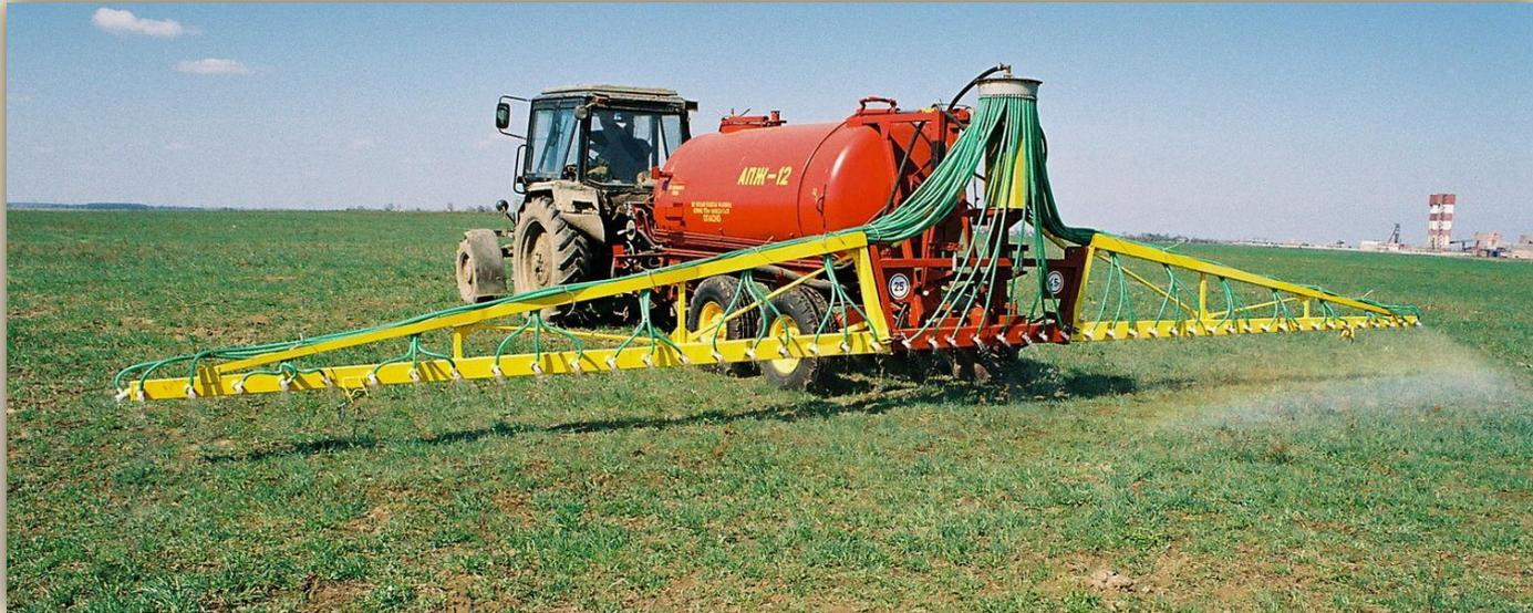
Агрегат для подкормки и внесения жидких минеральных удобрений **АПЖ-12**
