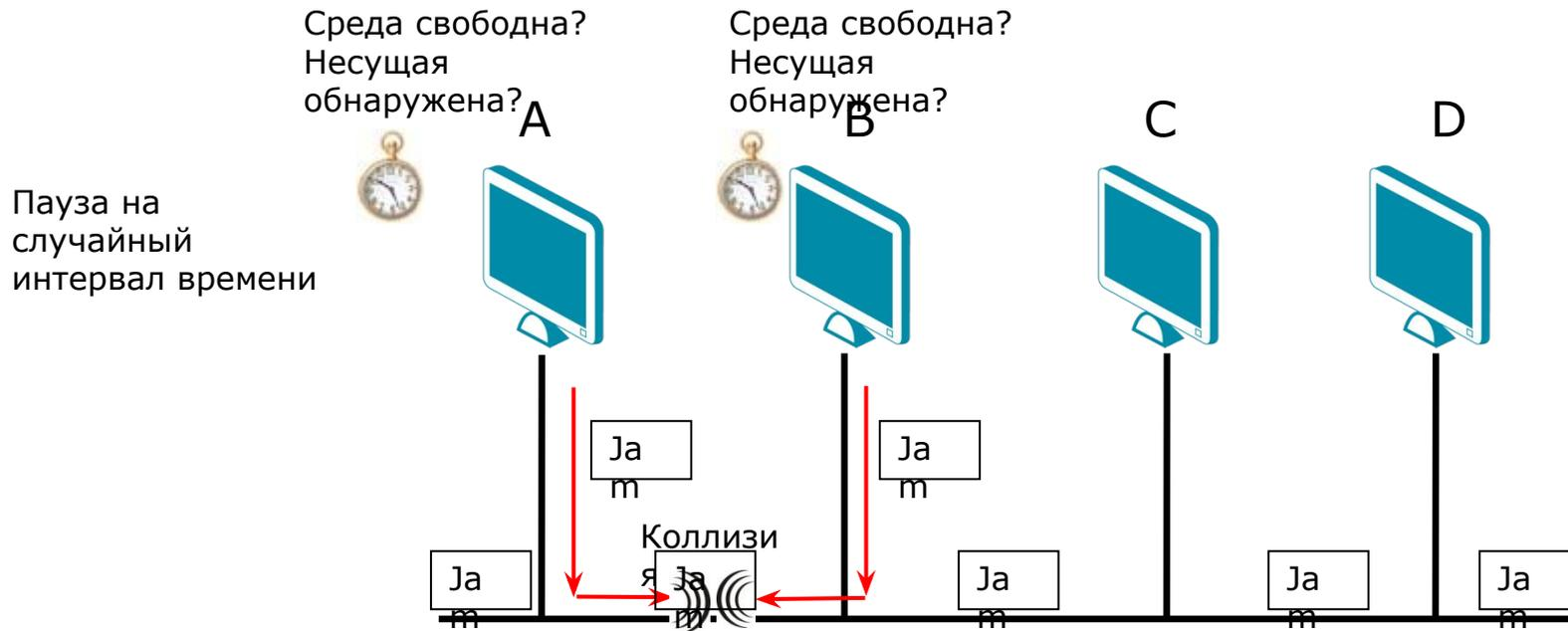
Если 16 последовательных попыток передачи кадра вызывают коллизию, то передатчик должен прекратить попытки и отбросить кадр.
