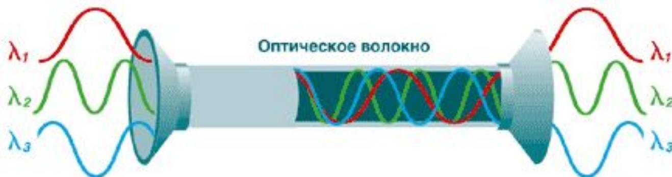
Рис. 2. Мультиплексирование в *DWDM*.
