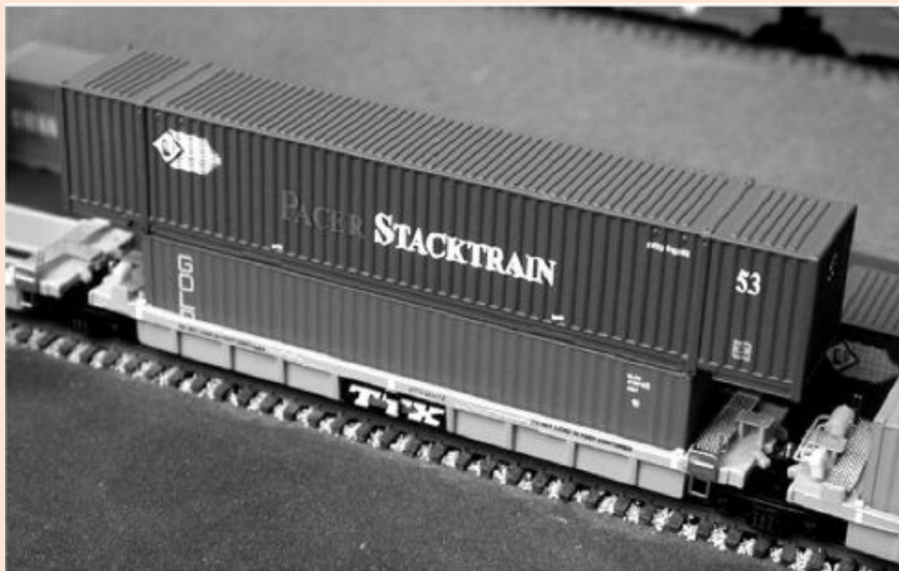
Рис. 10.14. Железнодорожная контейнерная платформа для двухъярусной установки контейнеров: внизу — морской 40-футовый контейнер, вверху — «континентальный» контейнер длиной 53 фута (США)
