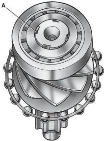
4.12. сурет. Басты беріліс шпегін сығымдап орнатқаннан кейін шеткі ұшын тұйықтау: A - тұйықталу орны.
