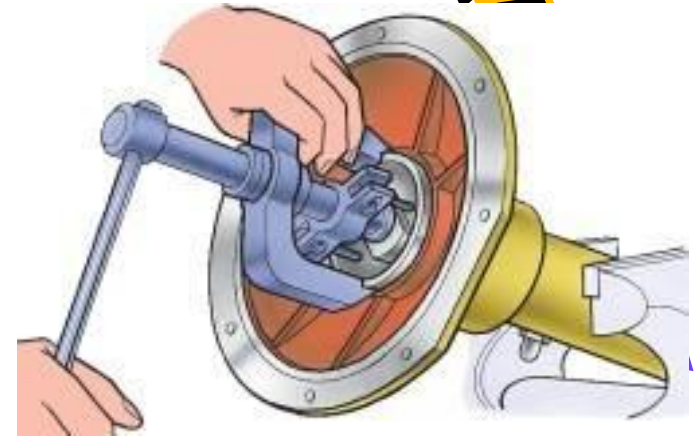
4.3.сурет. Дифференциалдың ішпегінің сыртқы сақинасын престеп итеріп шығару.
