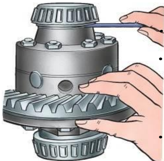
4.10. Сурет. Дифференциал ішпектерін реттеген кезде саңылауын өлшеу.
