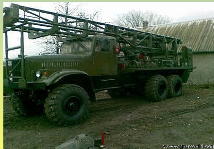
Бурова установка ПБУ-200
