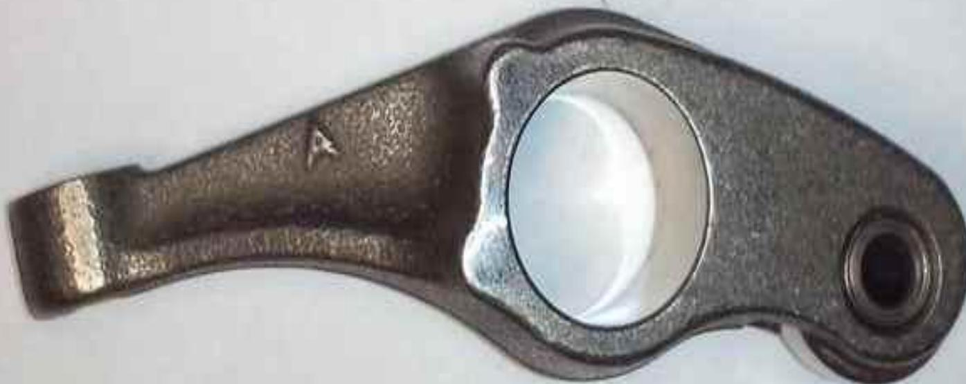
Коромысла отливают из чугуна и стали методом точного литья или штампуют из стали
