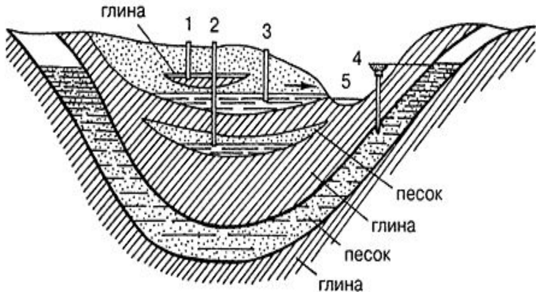
**Схема залегания подземных вод:** 1 — верховодка; 2 — межпластовые безнапорные воды; 3 — грунтовые воды; 4 — межпластовые напорные воды; 5 — поверхностный водоем
