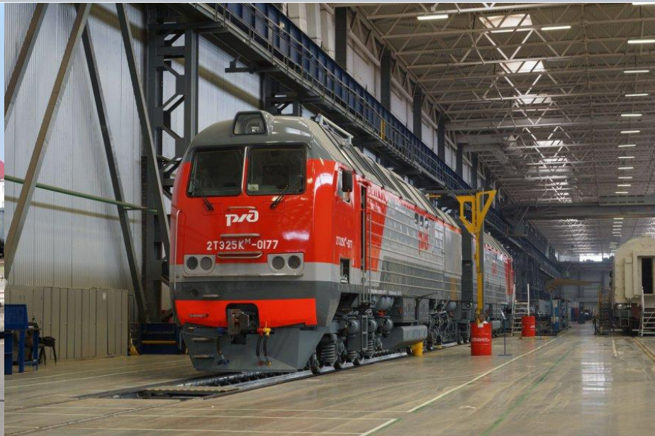
Магистральный локомотив 2ТЭ25Км
