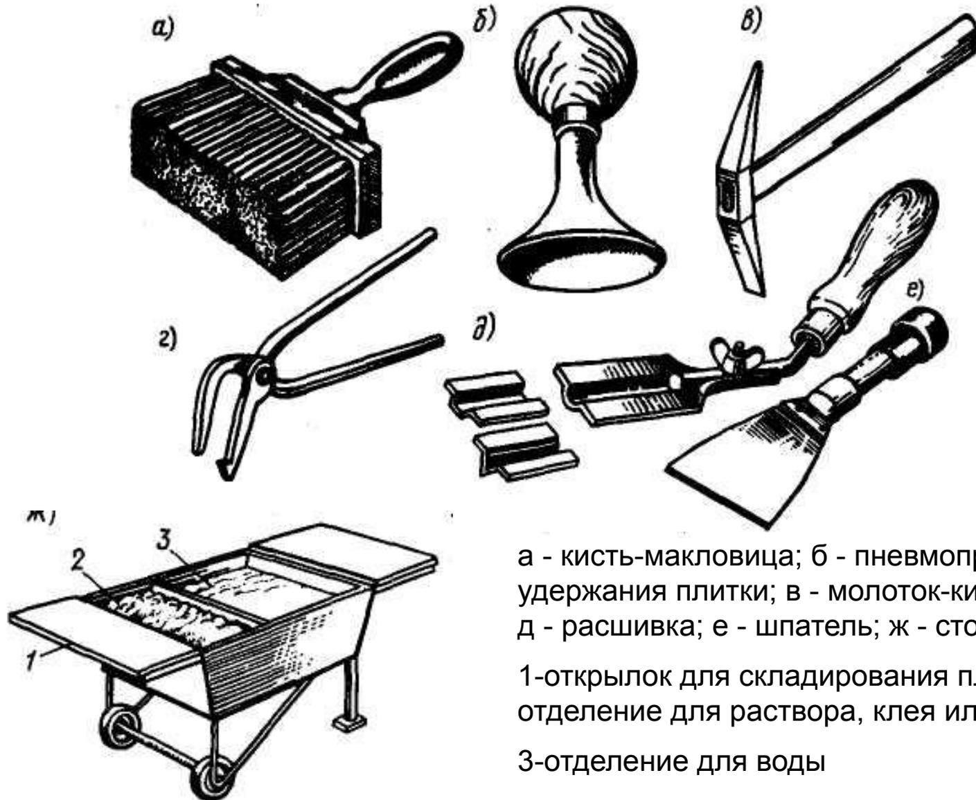
а - кисть-макловица; б - пневмоприсос для удержания плитки; в - молоток-кирочка; г - кусачки; д - расшивка; е - шпатель; ж - стол плиточника
