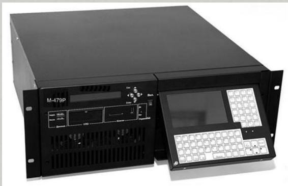
**Изделие КМ-МПМ** (изделие М-479Р) - специализированный комплекс программно-технических средств (КПТС), являющийся аппаратно-программным шифровальным средством, предназначенным для обеспечения защиты передаваемой в сетях шифрованной связи 1 и 2 класса информации.
