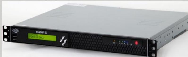
**Межсетевой экран** - программный или программно-аппаратный элемент компьютерной сети, осуществляющий контроль и фильтрацию проходящего через него сетевого трафика в соответствии с заданным правилом.
