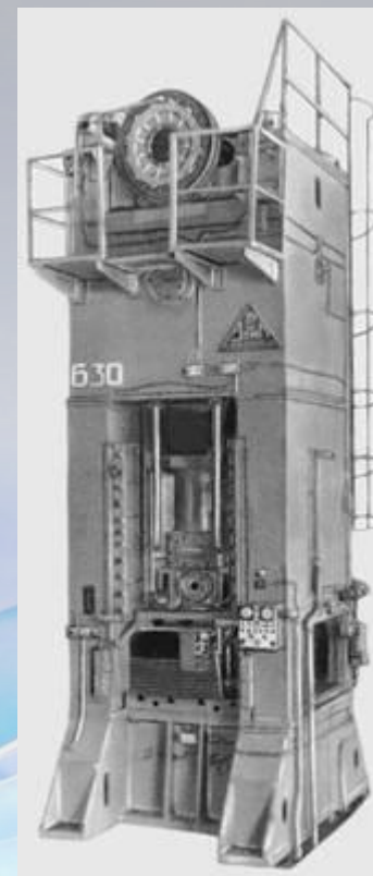
Рисунок 20 — Закрытый кривошипный пресс простого действия с усилием 6,3 Мн (630 тс)
