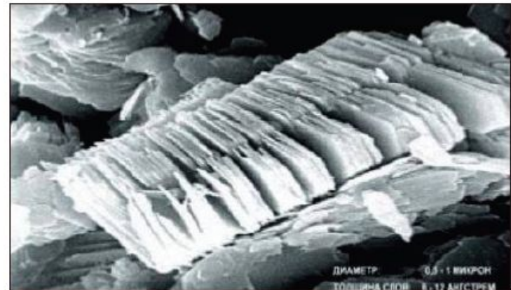
Рис. 6 Электронномикроскопический снимок. Пакеты (кристаллиты) монтмориллонита, группирующиеся в частицы.
