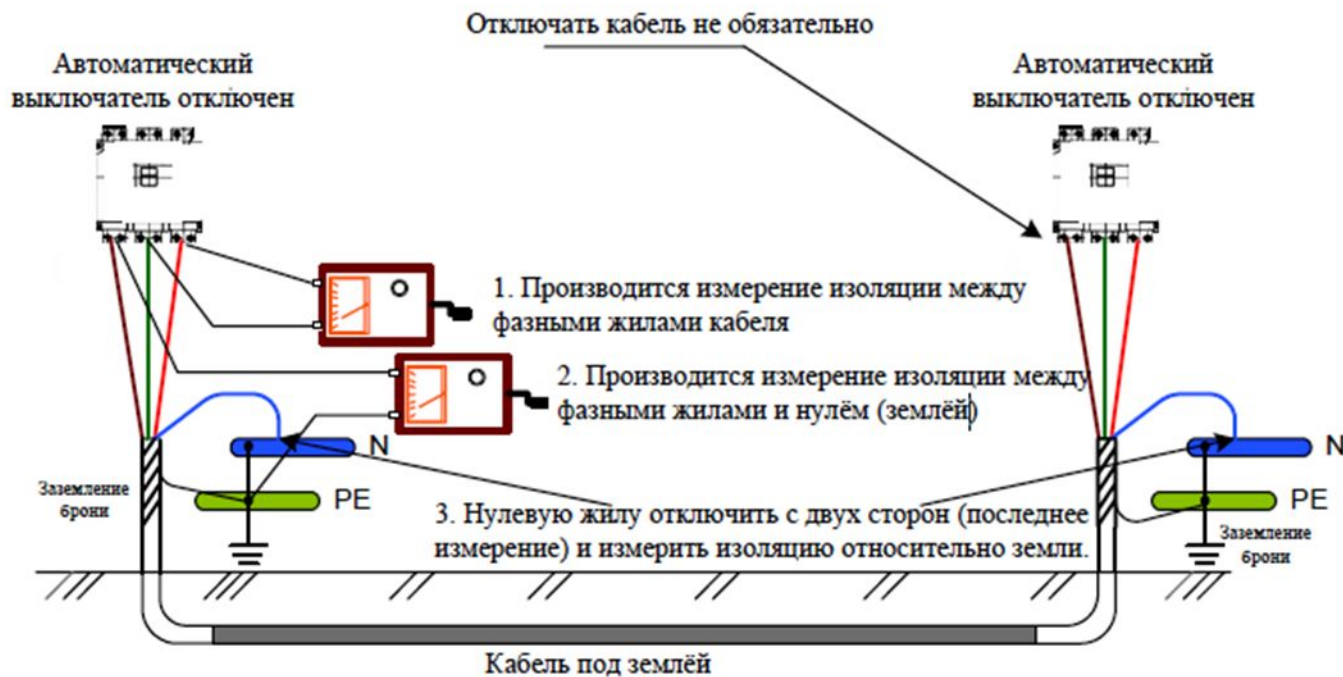
Рисунок 3. Измерение сопротивления изоляции силового кабеля в действующей электроустановке.
