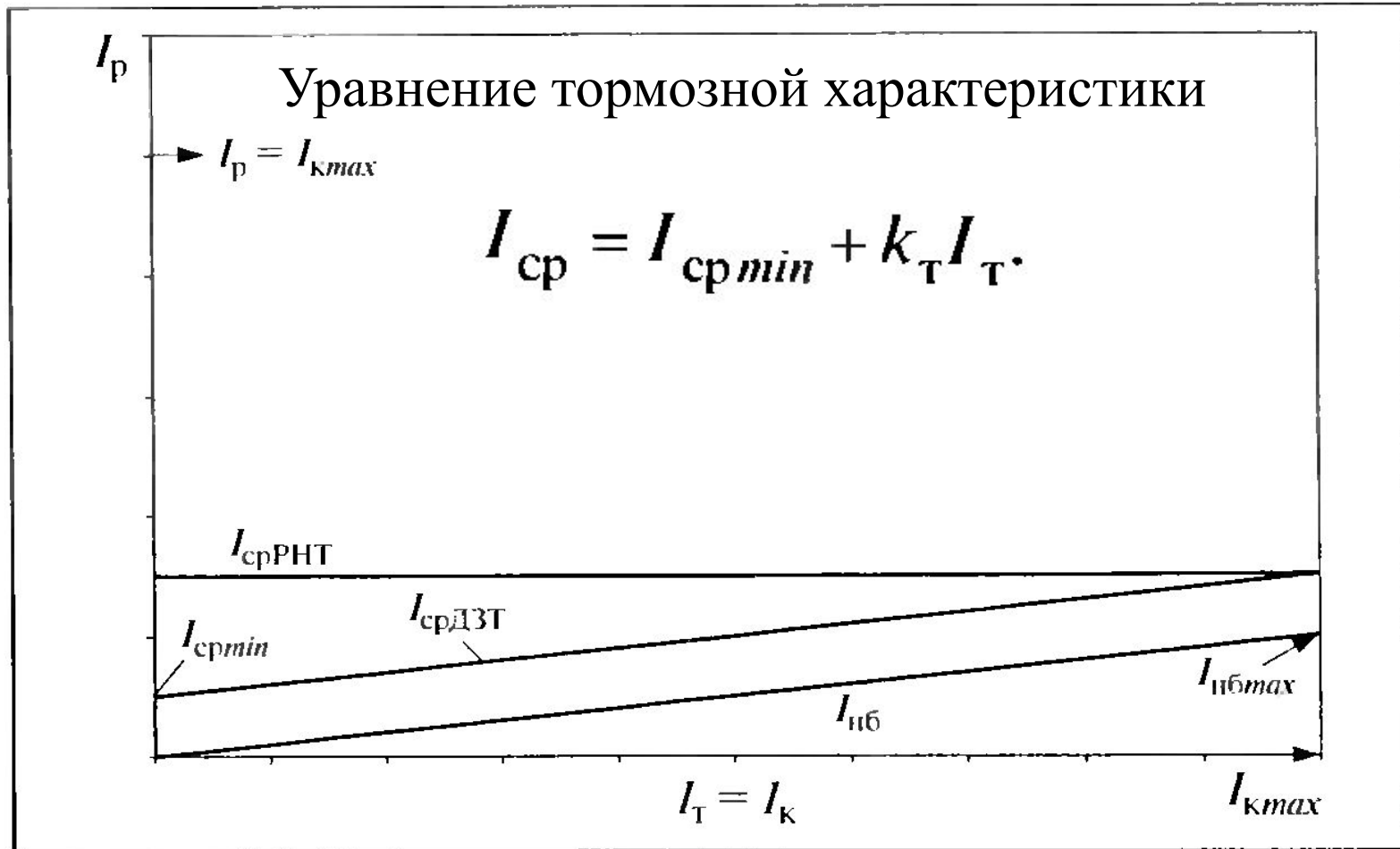
Рис. 17. Характеристика реле тока с торможением
