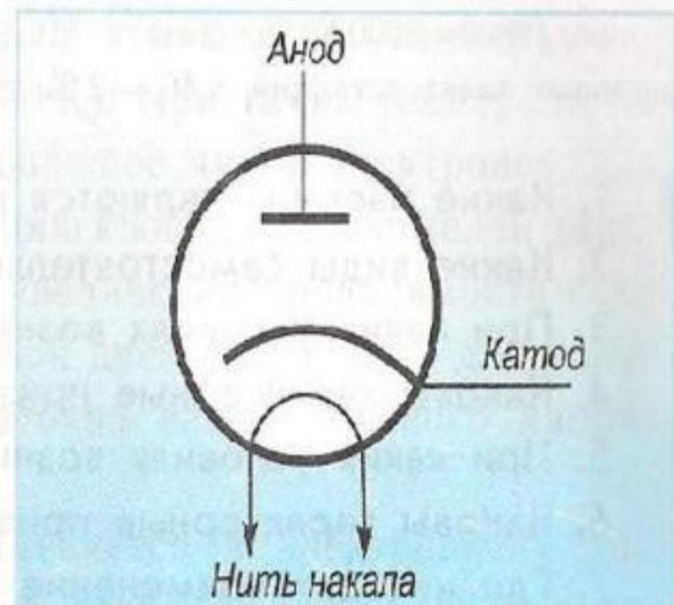
Рис. 2 Условное обозначение вакуумного диода
